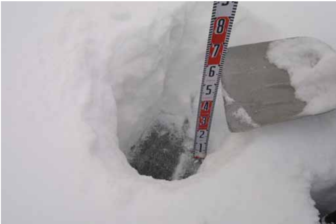
Kuva 9. Poliisin tekniikan tutkijat punnitsivat katolla olleen lumen 55 cm paksulta kohdalta. Pohja oli kuiva. (Kuva poliisin tekniikka.)
