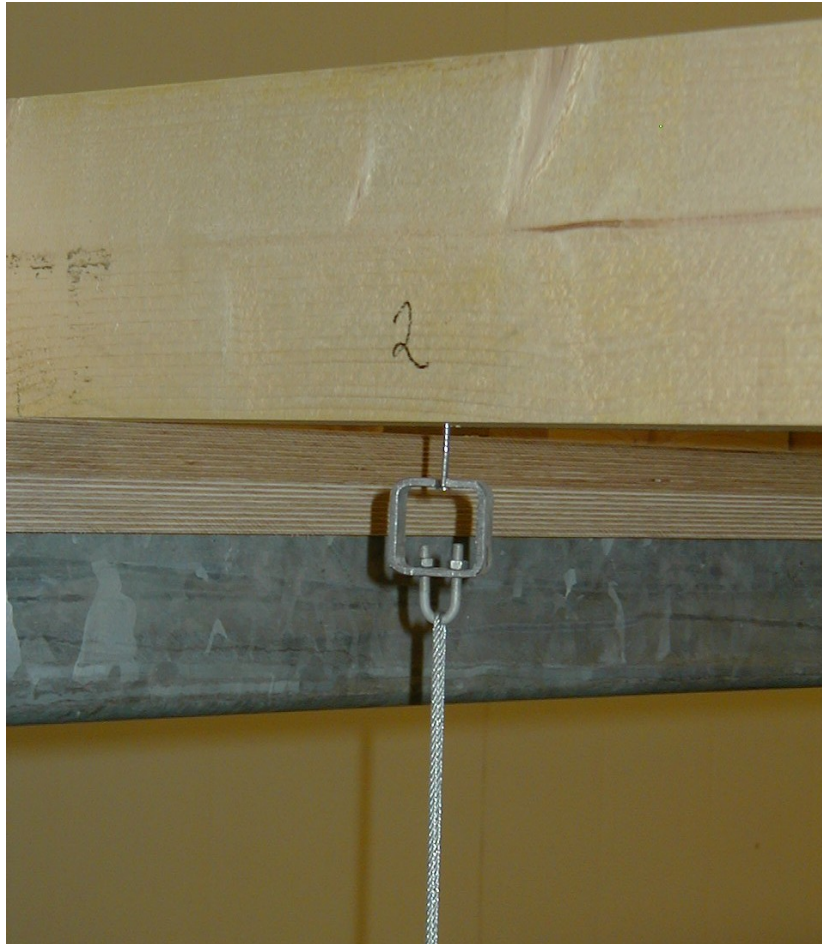
Kuva 5. Ripustuskuorman kiinnitysjärjestely naulan kantaan.
