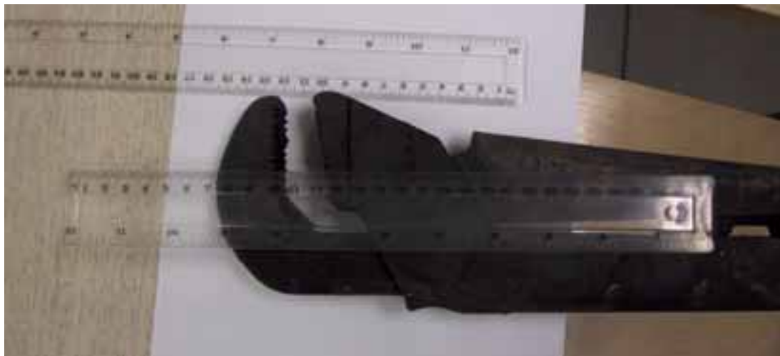
Kuva 7. Kuvassa putkipihdit, joilla onnettomuusventtiiliä yritettiin avata. Pihtien leuat ovat auki venttiilin käsipyörän akselin paksuuden verran.
