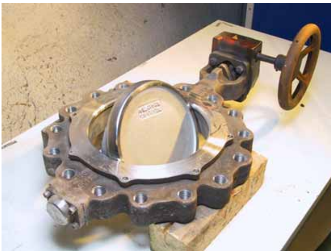
Kuva 12. Ehjä venttiili, joka on samaa tyyppiä kuin onnettomuusventtiili.
