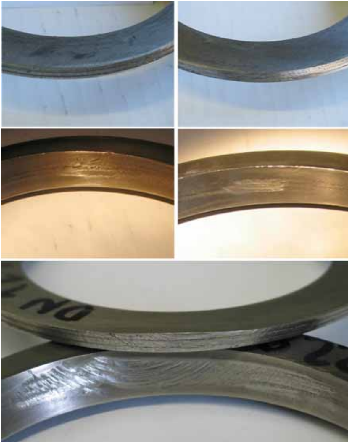
Kuva 24. Vaurioitumisjälkiä kolmessa tehtaan argonputkiston venttiilissä. Kuvissa näkyy läpän ja venttiilin rungon metallitiivistepintojen toisiaan vastaavat vauriot.
