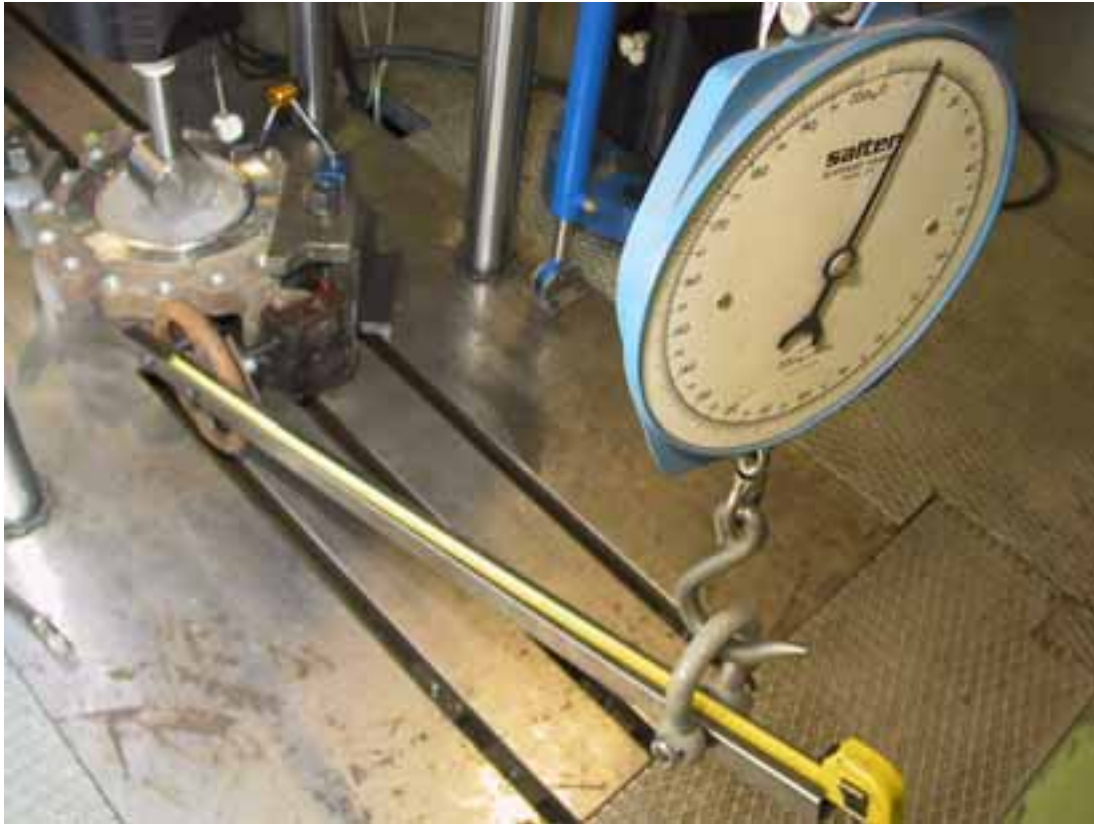
Kuva 20. Koejärjestely paine-eron alaisen venttiilin avaamismomentin mittaamiseksi vaa'alla.
