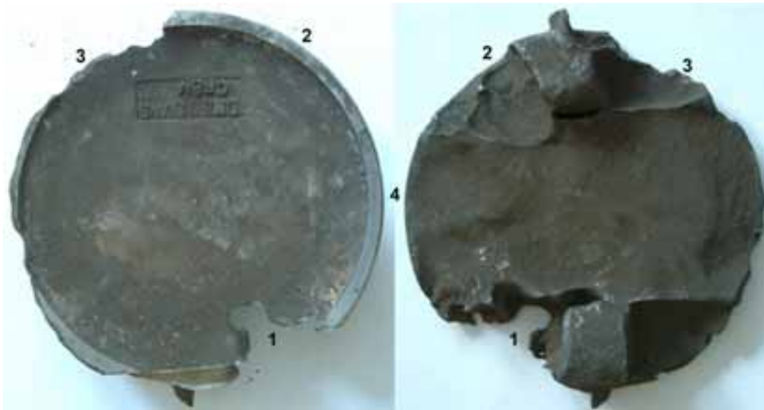
Kuva 15. Venttiilin läppä ylhäältä (vasemmalla) ja alhaaltapäin valokuvattuna. Vasemmassa kuvassa läpän oikea puolisko on auki asennossa ylävirtaan päin ja vasen puolisko painuneena alavirtaan. Vaihteen puoleisen akselin eli kara-akselin tynkä on kuvissa alhaalla.
