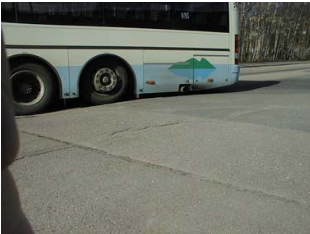
Kuva 2. Matalalattiabussien maavara on niin pieni, että alhaalla oleva äänenvaimennin voi osua helposti esimerkiksi kadun reunakivetykseen.
