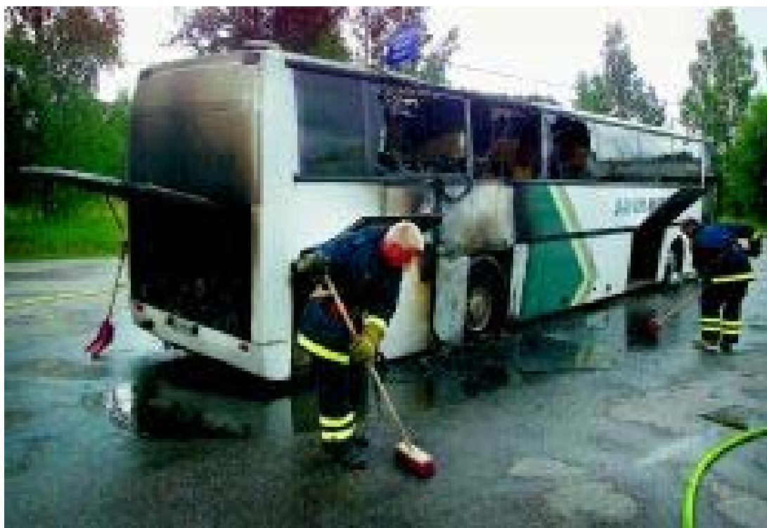
Kuva 8. Vaurioitunut auto. Tuli siirtyi ikkunan kautta matkustamoon.
