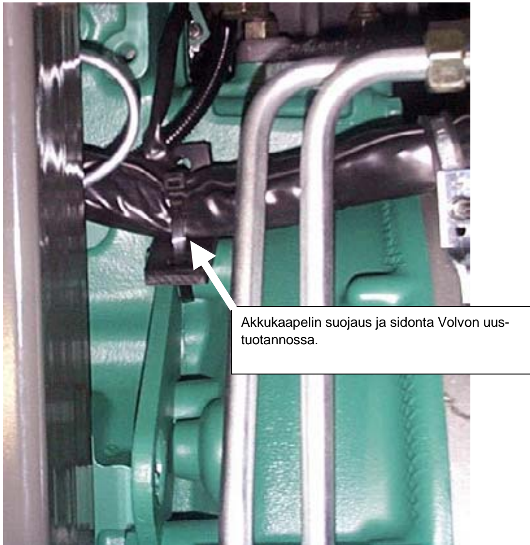
Kuva 23. Volvon uustuotannossa toteuttama kaapelin sidonta. Nostokorvake sidonnan alapuolella. (Kuva Volvo Ab)
