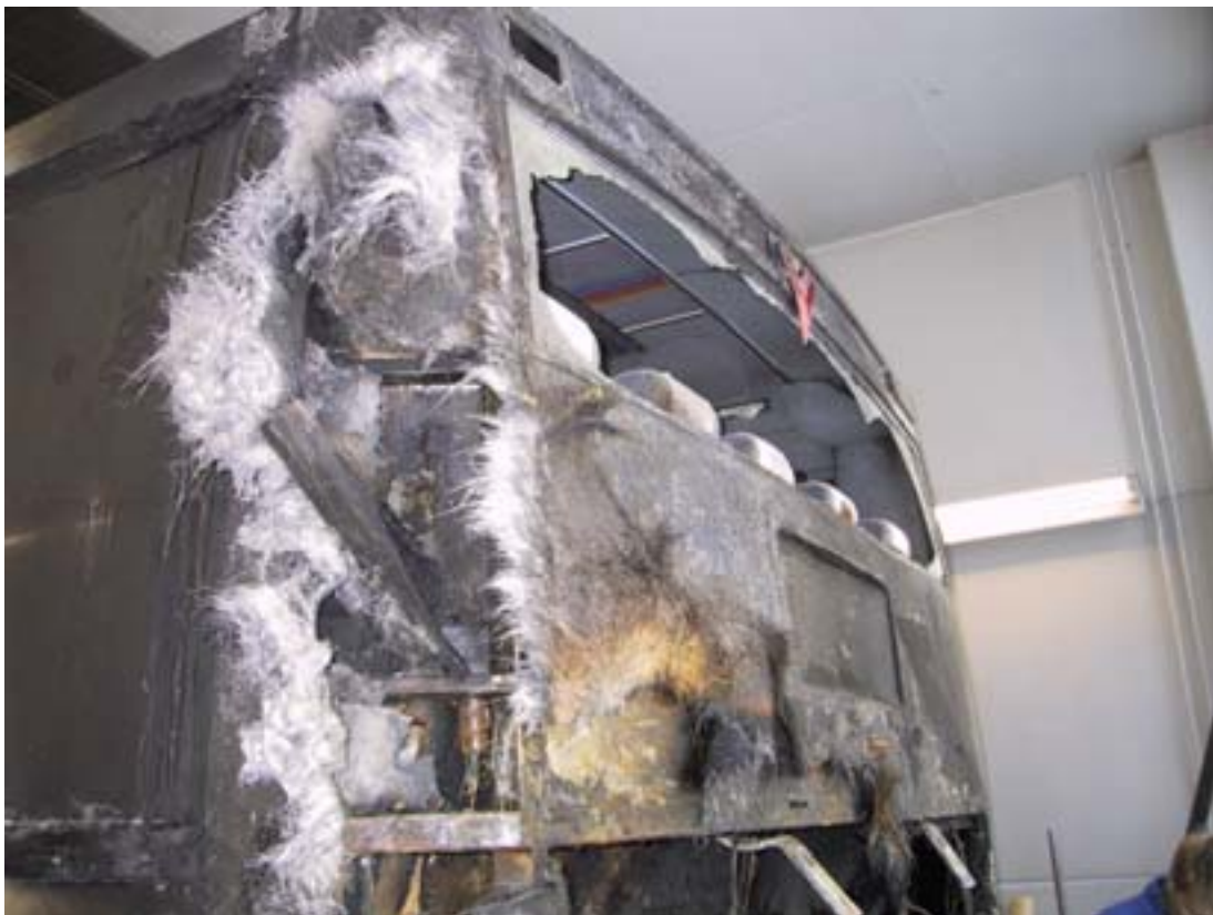
Kuva 12. Auton vaurioitunut taka-osa. Tuli ei levinnyt matkustamoon. Takaikkuna rikkoutui sammutettaessa paloa.
