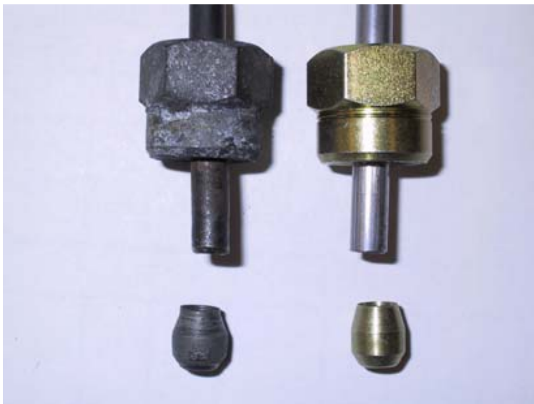
Kuva 6. Vasemmalla irronnut helmiliitin ja oikealla uusi.
