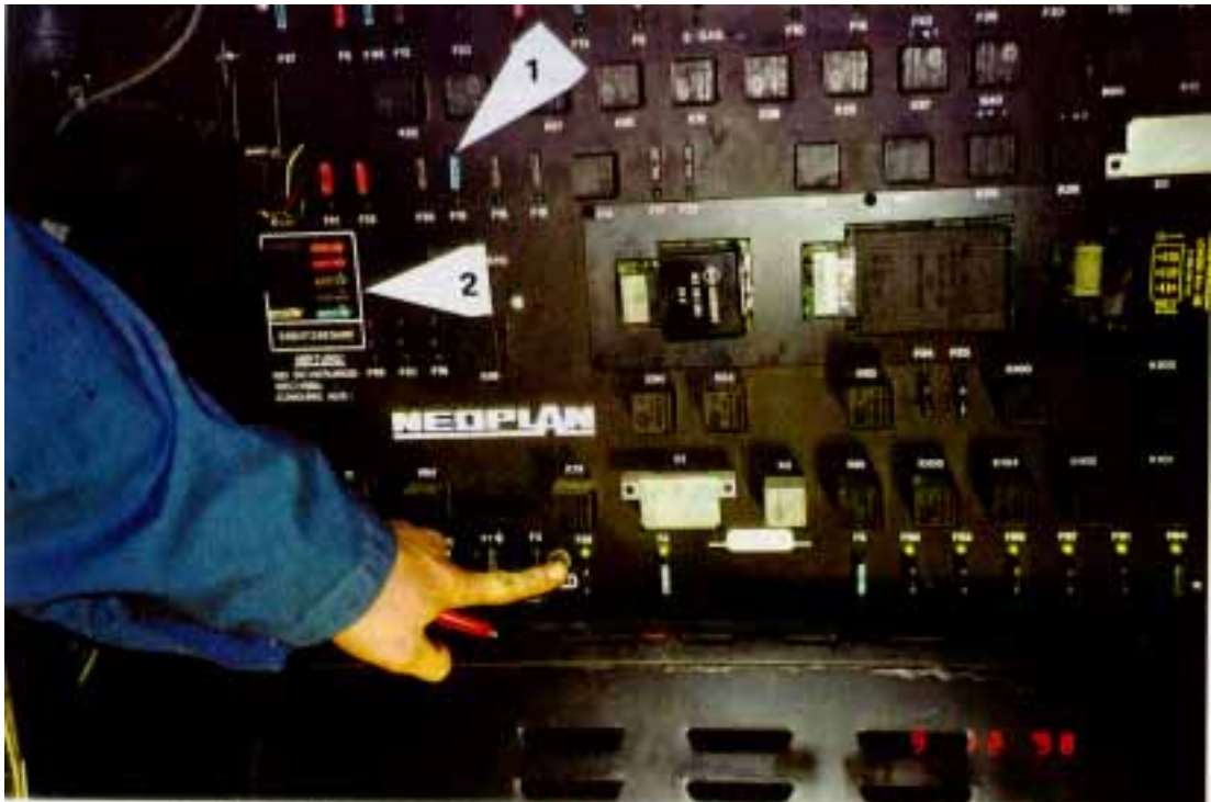
Kuva 1 Sähkökeskus suojuu avattuna. Nuoli 1 osoittaa väärää kokoa olevan sulakkeen F15. Nuoli 2 osoittaa varasulakkeita.
