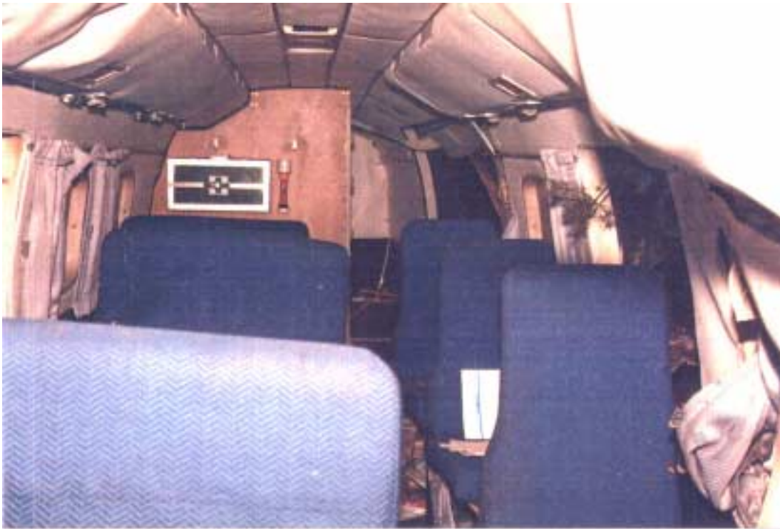
Matkustamo taaksepäin kuvattuna. Osa matkustamon istuimista oli viety ulos pelastustoimien yhteydessä. Yhden istuimen vyö oli katkennut törmäyksessä.
