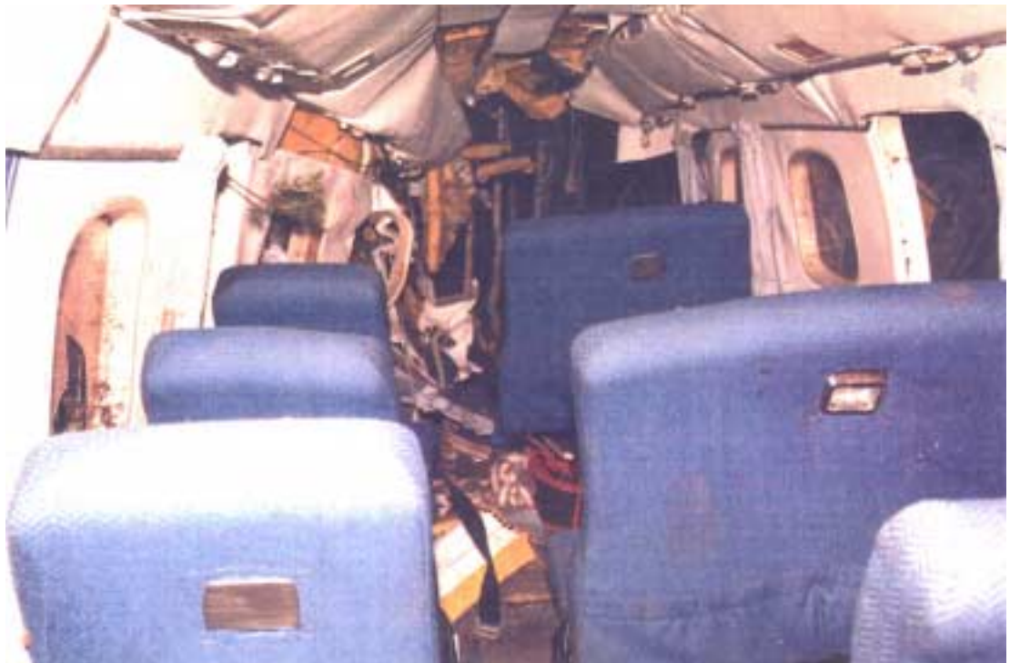
Kuva matkustamosta. Kuva on otettu takimmaisesta istuimen kohdalta. Vasemman takimmaisesta matkustamon ikkunan rikkoi siihen kojetaulusta sinkoutunut moottorinvalvontamittaristo. Oikeanpuoleinen varauloskäynti irtosi törmäyksessä ja vasemman avasi matkustaja.
