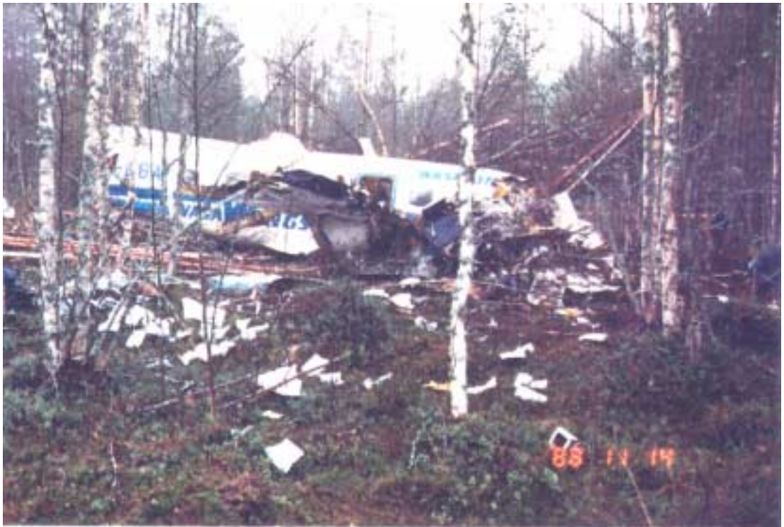
Lentokoneen hylky oikealta kuvattuna. Oikean siiven etupuolella on ohjaamon ja matkustamon etuosan jäännökset. Etualalla on lentokoneeseen ja lentoon liittyneitä asiakirjoja.
