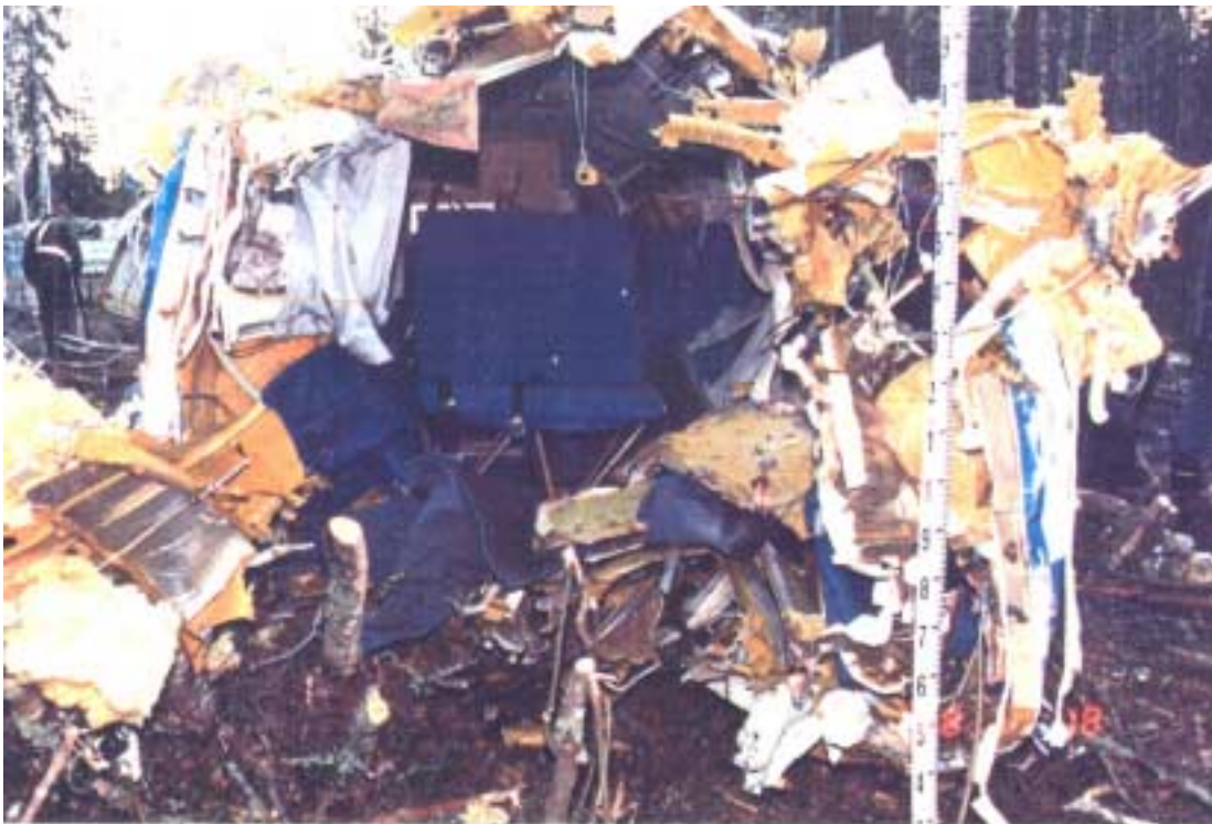
Runko edestä kuvattuna. Rungosta puuttuu ohjaamo ja matkustamoja toiselle penkkiriville asti.
