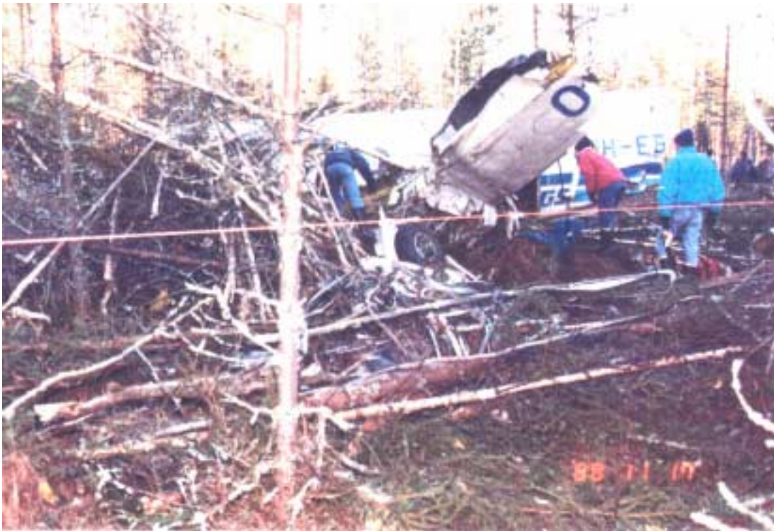
Hylky vasemmalta puolelta kuvattuna. Vasen siipi on murskaantunut ja sen polttoainesäiliö on repeytynyt sekä tyhjentynyt maastoon. Vasen moottori on kuvassa etualalla.
