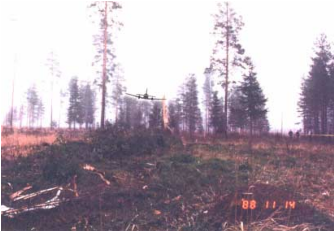
Näkymä lentokoneen törmäysuralta tulosuuntaan kuvattuna. Kuvauspaikan etäisyys ensimmäisestä puuhuntörmäyspaikasta on noin 100m. Leikkautuneessa puustossa näkyy lentokoneen törmäyshetken asento (kuvaan lisätty lentokoneen siluetti).
