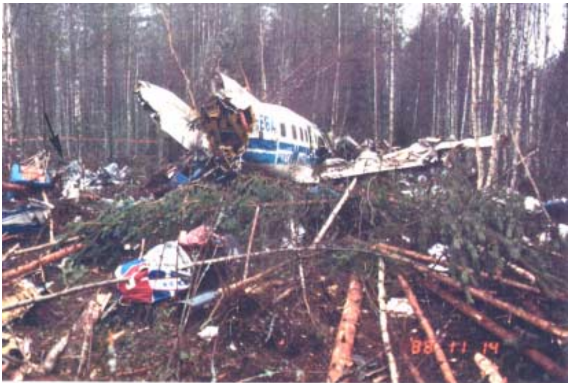
Hylky takaa kuvattuna. Etualalla on rahtitilasta pudonneita matkatavaroita. Nuoli osoittaa palanutta vasenta moottoria.
