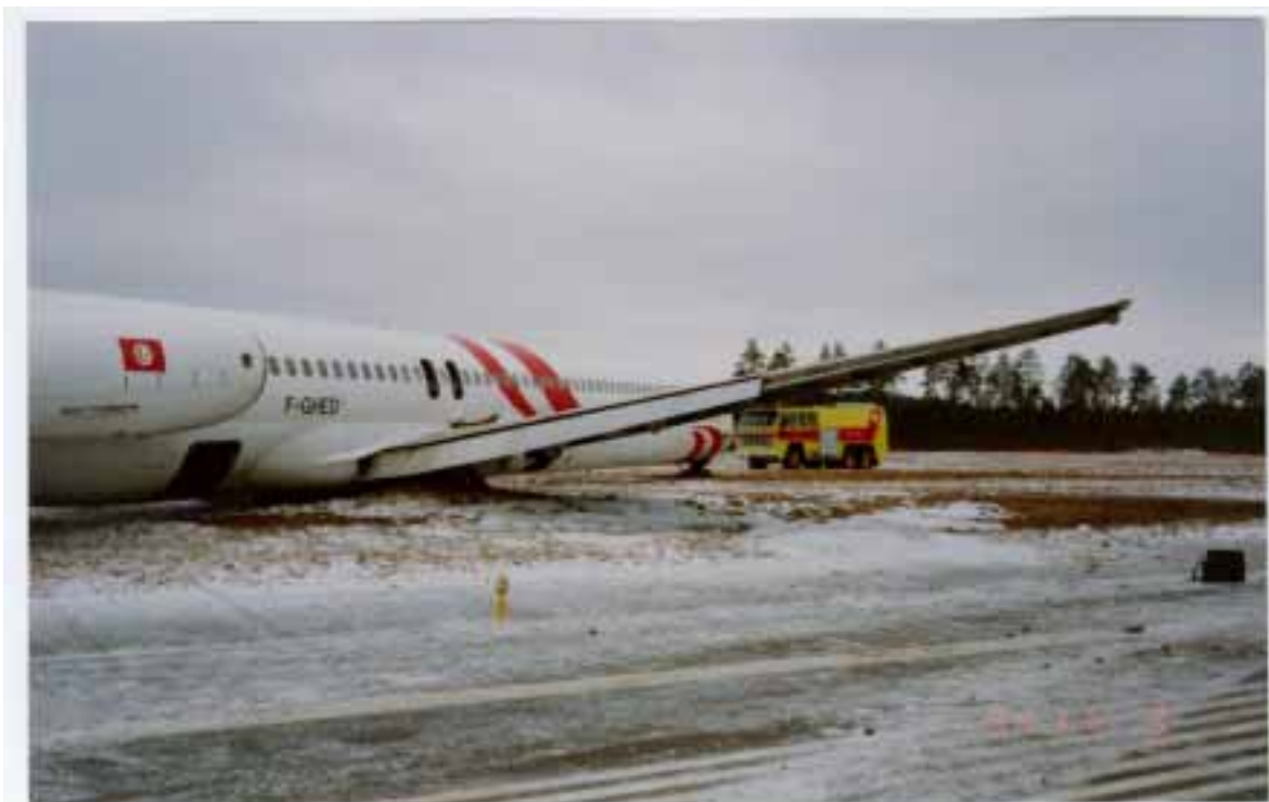
Kuva 3. Oikea pääteline on kaivautunut maahan. Runko on normaalia matalammalla.
