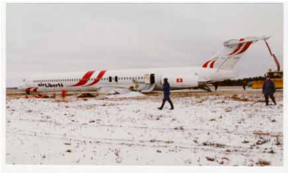
Kuva 2. Lentokoneen vasen pääteline on kääntynyt laskutelinekuiluun ja vasen siipi on vaurioitunut. Vasempaan siipeen syntyi polttoainevuoto. Evakuointi tapahtui takakeittiön huolto-oven ja vasemmanpuoleisten siipivarauuskäyntien kautta lukuunottamatta kahta matkustajaa, jotka tulivat ulos oikeanpuoleisista siipivarauuskäynneistä.
