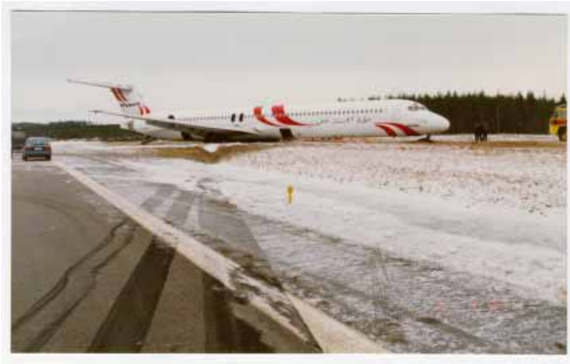
Kuva 1. Lentokone on kääntynyt 140 astetta kiitotien suunnasta oikealle ja pysähtynyt kiitotien ulkopuolelle. Peräsimet ovat kiitotien pään tasalla.
