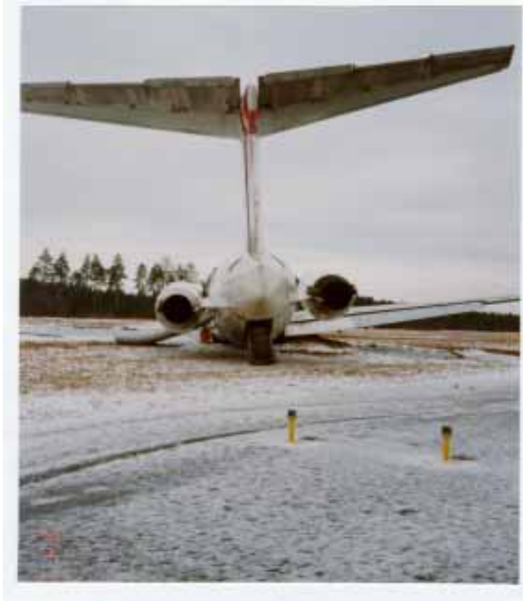
Kuva 3. Oikea pääteline on kaivautunut maahan. Runko on normaalia matalammalla.
