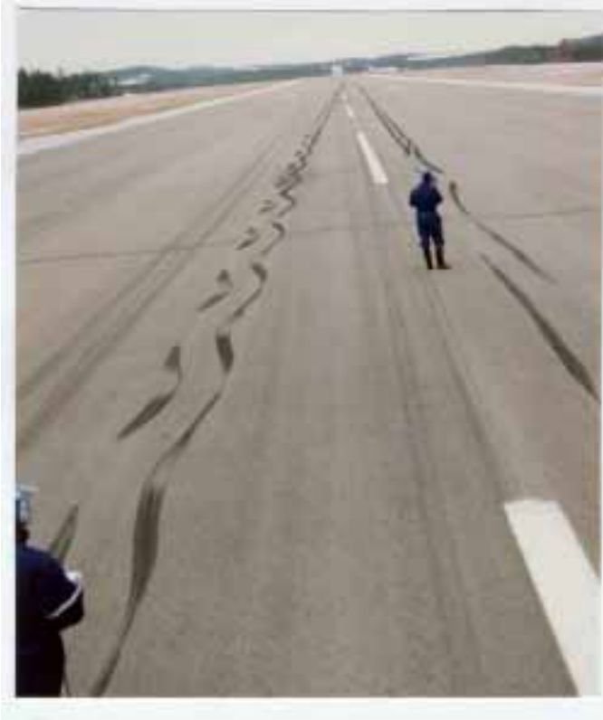
Kuva 5. Molempien päälaskutelineiden jäljet laskusuuntaan kuvattuna. Vasemman laskutelineen pyöräparin jälkeen jäljet alkoivat mutkitella 190 m ja oikean 260 m päässä ensikosketusjäljistä.
