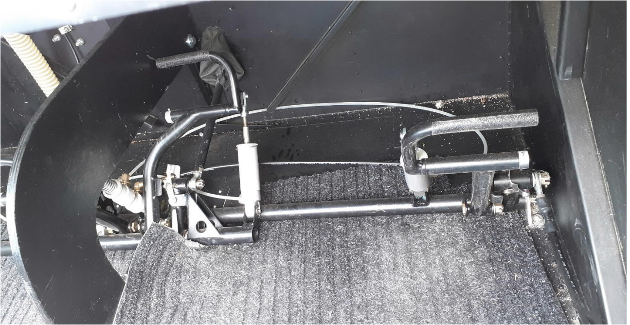
Kuva 4. Oikeanpuoleiset polkimet. Kuvan oikeassa reunassa näkyy ehjä sivuperäsimen vaijerin kiinnitys. Vasemmassa reunassa on polkimien välinen levy, joka estää tahattoman rinnakkaispolkimen käytön. (Kuva: OTKES)
