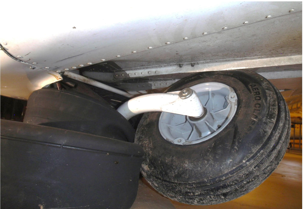
Kuva 5. Nokkateline on taittunut ja kääntynyt vasempaan. (Kuva: OTKES)
