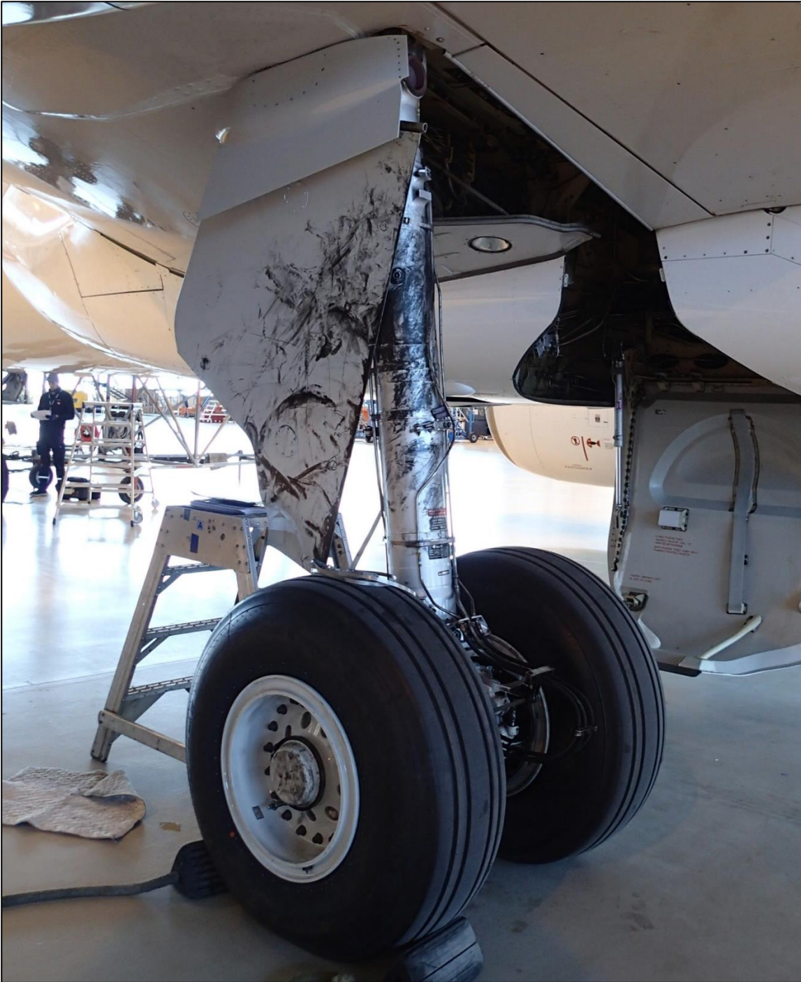
Kuva 3. Yleiskuva koneen vaurioituneesta vasemmasta päälaskutelineestä. Rikkoontunut ulompi rengas on vaihdettu ennen koneen siirtoa halliin. (Kuva: OTKES)
