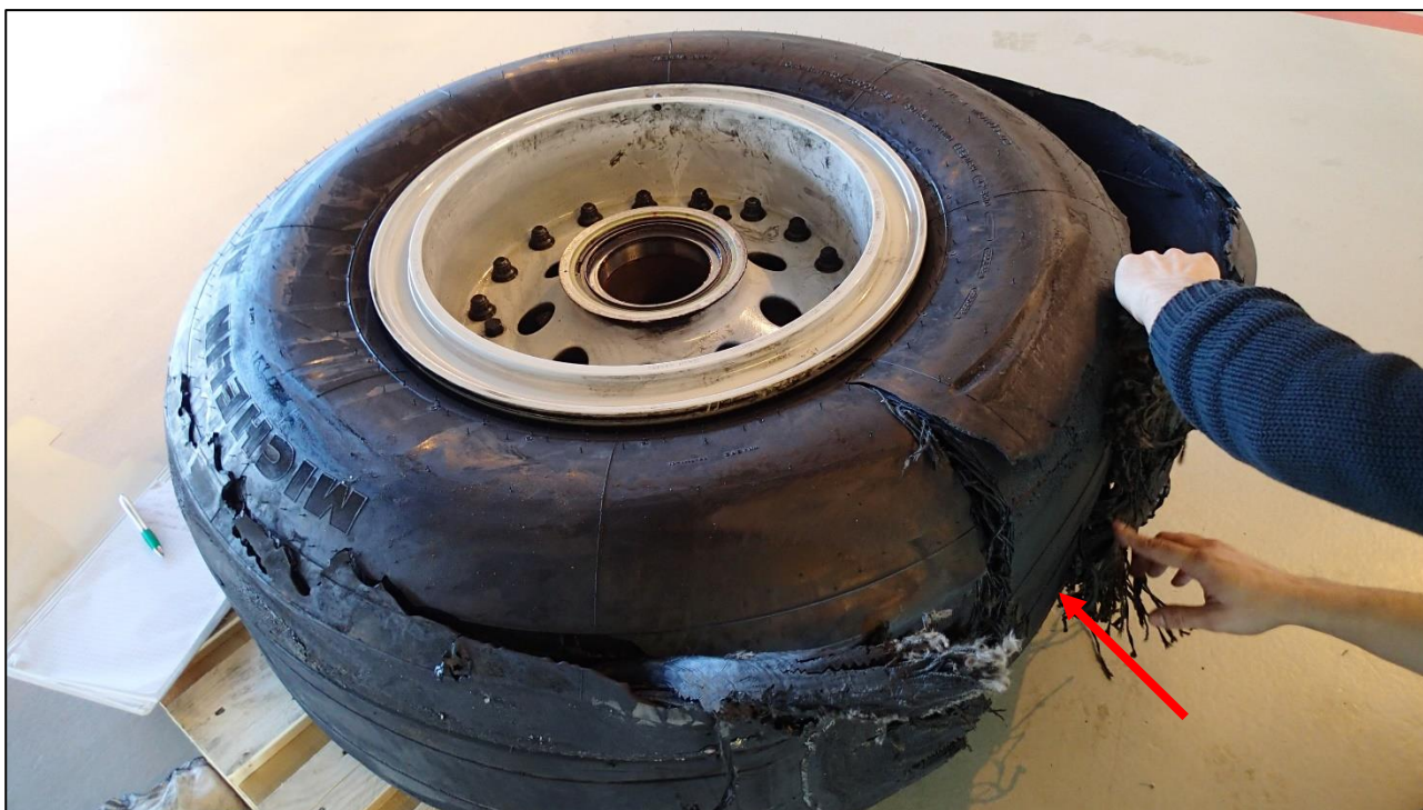
Kuva 4. Rikkoontunut rengas. Pyörän lukkiutuessa maata vasten ollut kohta kuvassa oikealla. (Kuva: OTKES)
