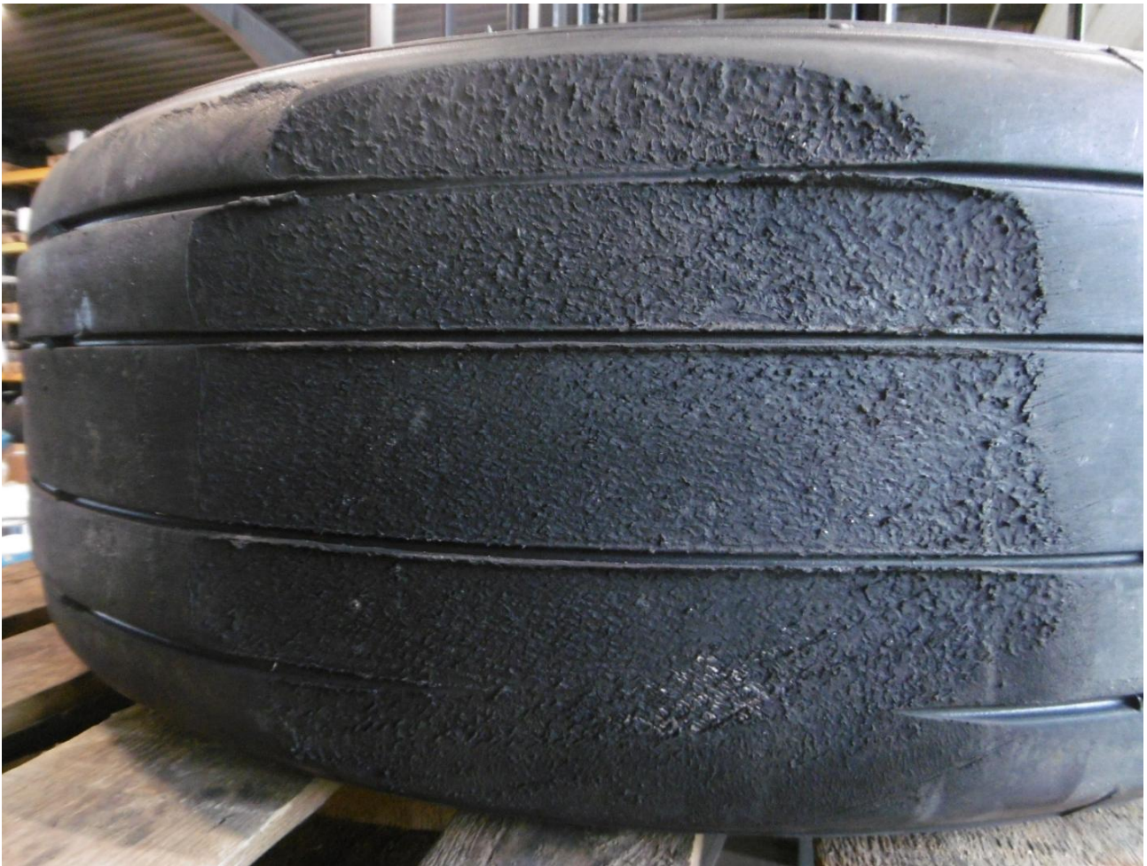
Kuva 15. Päälaskutelineen rengas 1. Vesiliirtotyyppi ”Reverted rubber”:sta aiheutuneita muutoksia renkaan kulutuspinnan kumiaineksessa. Tämä rengas ei osunut kiitotien reunavaloihin. (Kuva: CityJet)
