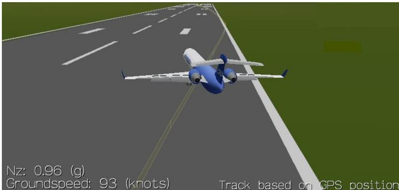
Kuva 3. Kuva lentokoneen FDR -tallenteen mallinnuksesta, jossa lentokone on laskeutumisen jälkeen sivuluisussa ajautumassa ulos kiitotieltä. Lentokoneen maanopeus kuvan hetkellä on noin 170 km/h. Vaaleankeltainen viiva perustuu tallentuneiden GPS-pisteiden sijaintiin. Kuvasta poiketen todellinen asfaltoitu alue ulottuu valkoisen reunaviivan ulkopuolelle. Lentokoneen renkaat eivät käyneet asfaltoidun alueen ulkopuolella. (Kuva: Insight™ ProView)
