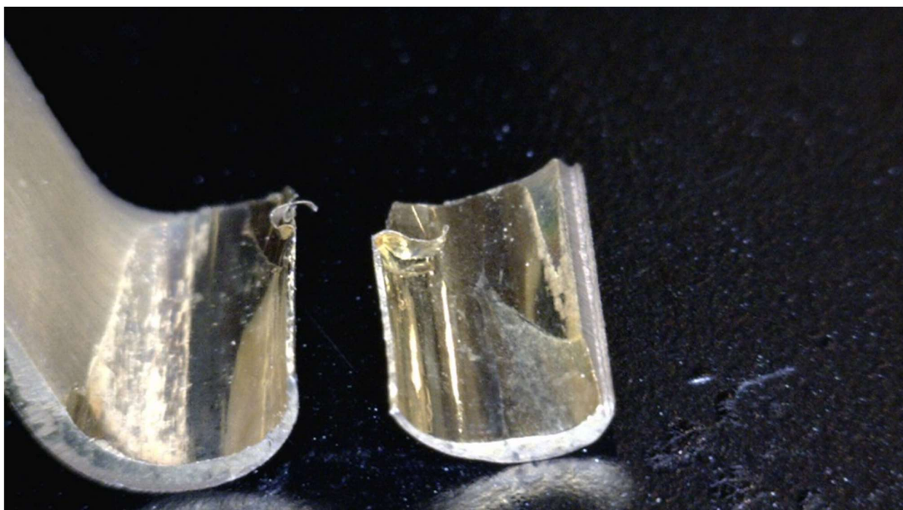
Kuva 11. Poikki kulunut kohoventtiilin vivusto. (Kuva: OTKES)
