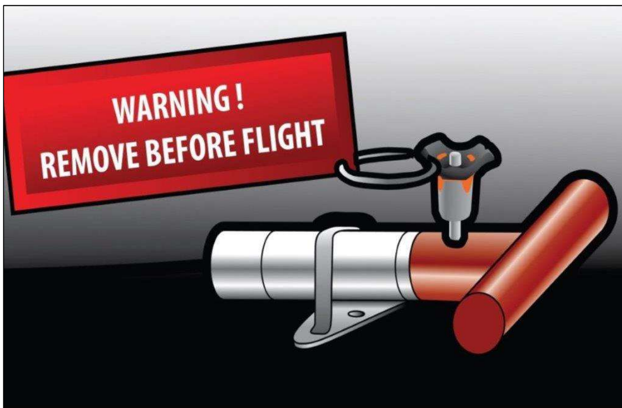
Kuva 6. Valmistajan käyttöohjekirjassa kuvattu varmistussokka (Kuva: Stratos 07 s.r.o.)
