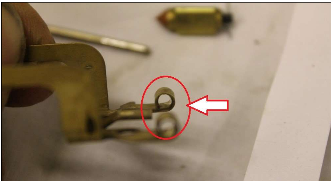
Kuva 16. Vivusto purettuna. Vivustossa on havaittavissa huomattavaa kulumista. (Kuva: OTKES)
