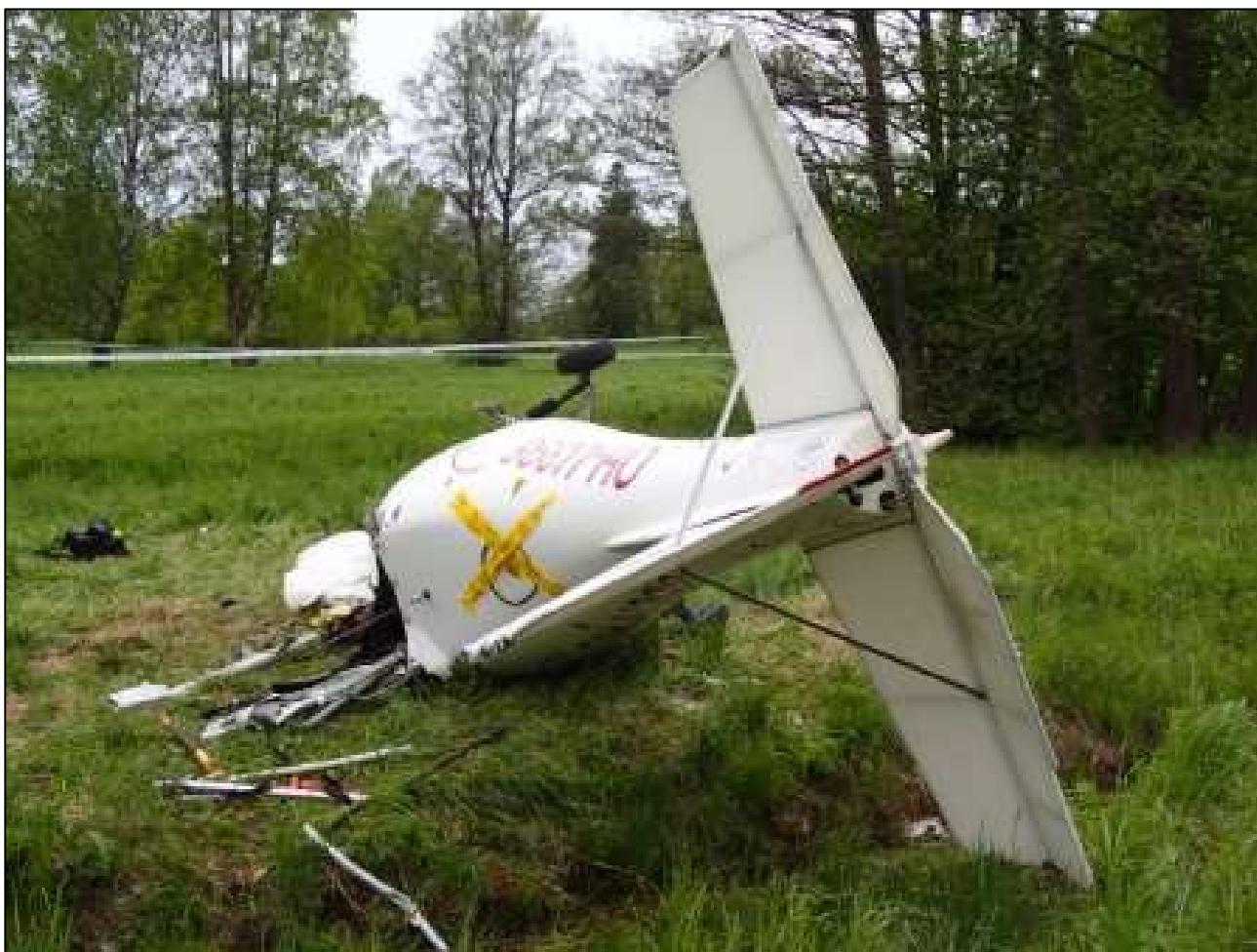
Kuva 2. Tuhoutunut Ikarus C42 OH-U398. Rakettivarjon ulostulokohta on merkitty pelastuslaitoksen keltaisin varoitusmerkinnöin. Oikea siipi irrotettiin pelastustoimien aikana. (Kuva: OTKES)
