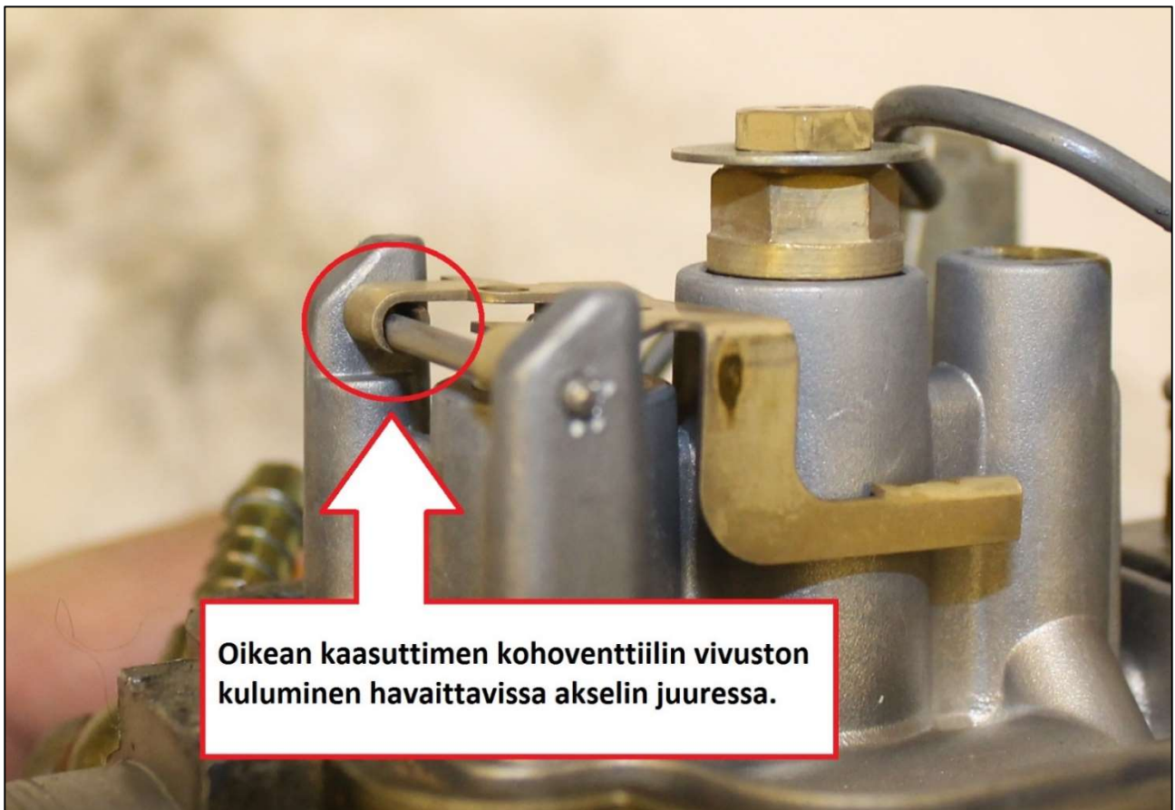
Kuva 12. Oikean kaasuttimen epänormaali kulumisen. (Kuva: OTKES)
