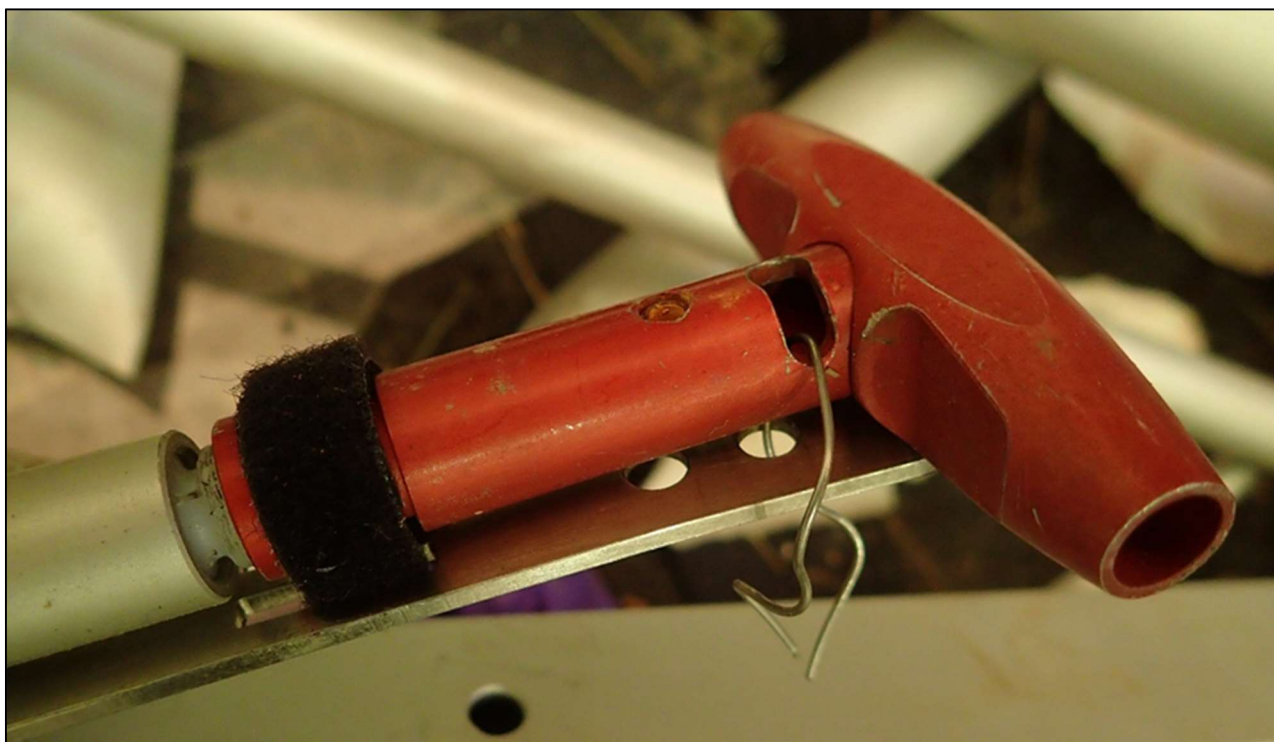
Kuva 5. Rakettivarjon laukaisukahva ja siinä oleva varmistuslangasta muotoiltu omatekoinen varmistussokka (Kuva: OTKES)
