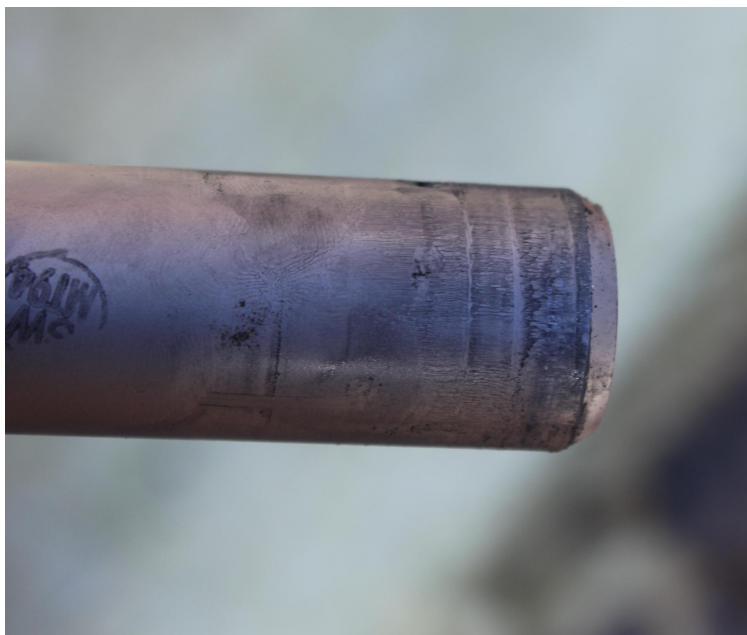
Kuva 4. Oikean päälaskutelineen etummaisen saranatapin taaempi, laskutelineen runkoon kiinnittyvä pääty onnettomuuden jälkeen. Kuva: Lapin Tilauslento Oy
