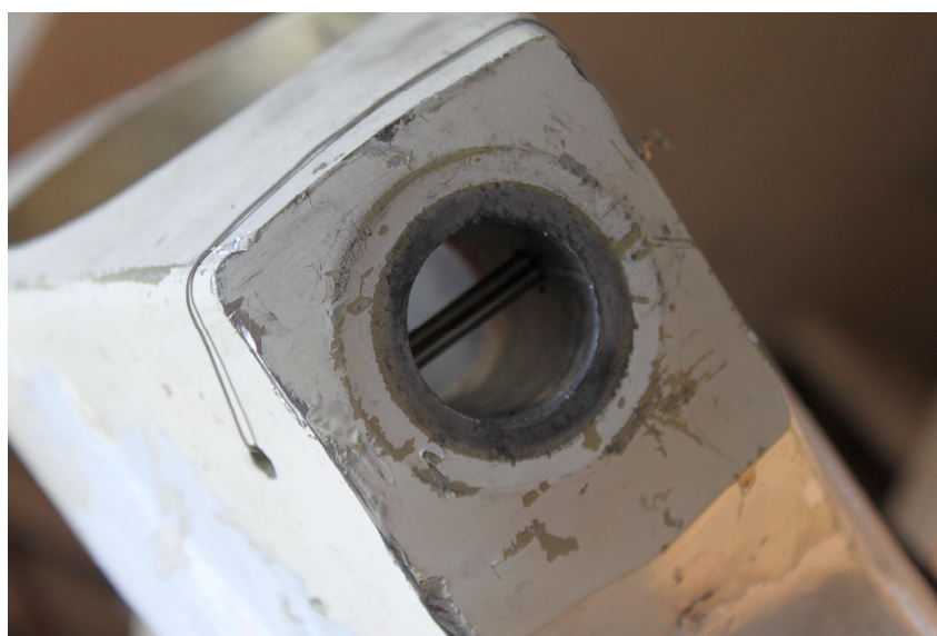
Kuva 5. Oikean päälaskutelineen etummaisen saranatapin varmistussokka paikoillaan onnettomuuden jälkeen. Kuva: Lapin Tilauslento Oy
