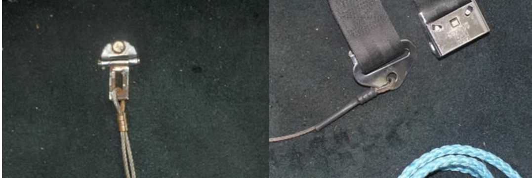
Kuva 7. Vasemmalla istuinvöiden vaijerikiinnitys lattiaan, oikealla istuinvöiden vaijerikiinnitys lentoyöhön (Kuva: OTKES)
