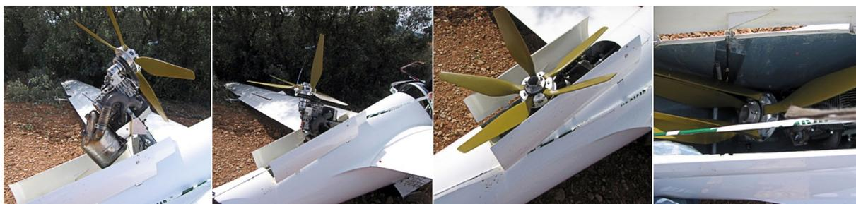
Figura 1. Secuencia de retracción del motor
