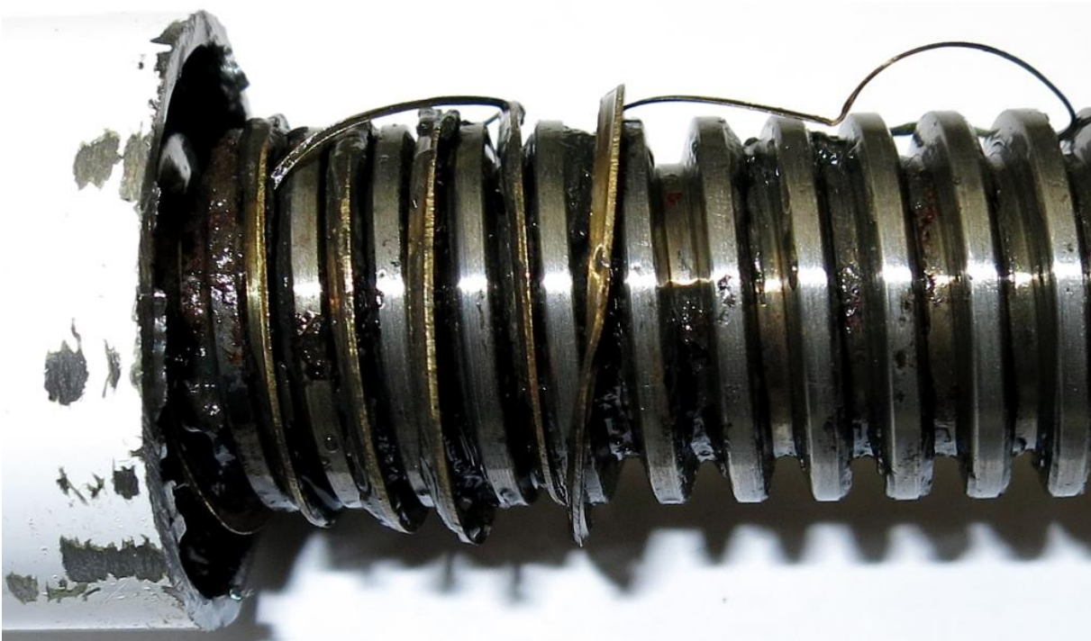
Kuva 5. Rasvapesun jälkeen aivan ruuviosan tyvestä löytyivät mutteriosasta irti leikkautuneet pronssikierteet. Mutterikierteen murtopinnan leveydeksi mitattiin noin 0,4 mm, joka vastaa kuvassa 3 erottuvaa murtopintaa. (Kuva: Onnettomuustutkintakeskus)
