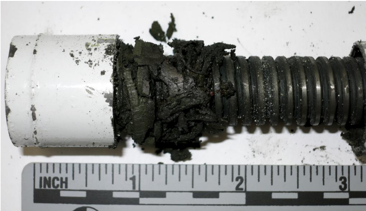
Kuva 4. Käyttölaitteen ruuviosan kuori leikattiin auki. Aivan ruuvin tyvessä oli saostunutta voitelurasvaa ja pronssihiukkasia. Rasvan seasta erottui erivärisiä kerrostumia. Alimpana myös väriltään punaista rasvaa pieni määrä. (Kuva: Onnettomuustutkintakeskus)
