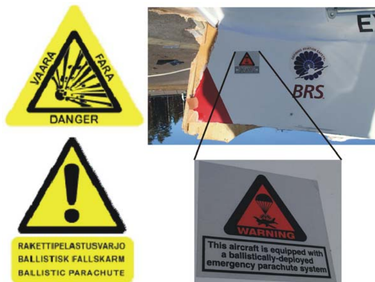
Kuva 4. Oikealla OH-XAC:een asennetun järjestelmän varoitusmerkintä koneen kyljessä. Varoitusmerkin koko oli noin 50 mm. Vasemmalla on määräyksen M3102/06 mukainen varoitusmerkintä, jonka kokovaatimus on 120 mm. Raketin laukaisuaukkoa osoittava merkintä puuttui onnettomuuskoneesta. (Kuvat: Onnettomuustutkintakeskus ja Liikenteen turvallisuusvirasto)
