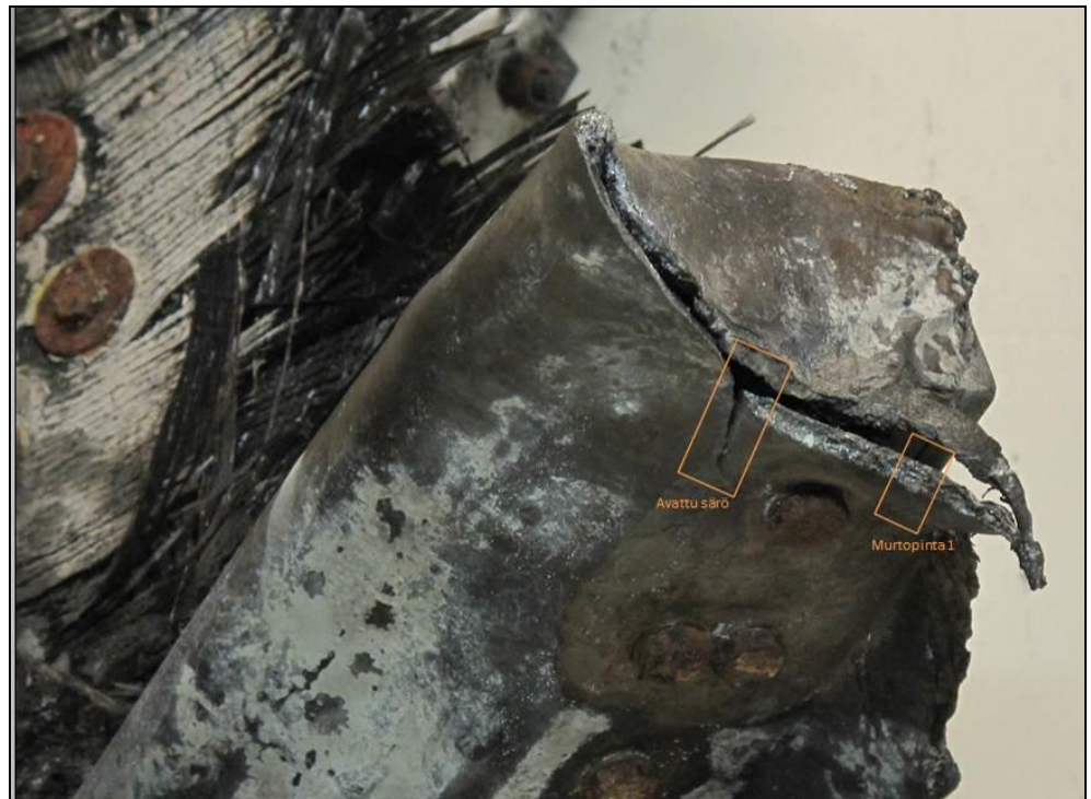
Kuva 7. Murtunut alumiinirakenne ja irtileikattujen näytepalojen paikat murtopinta 1 ja avattu särö.
