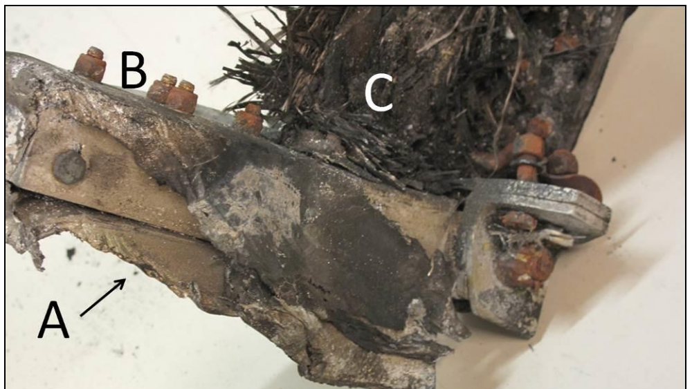
Kuva 6. Murtunut alumiinirakenne (A) tuen yläpintaa, (B) tuen alapintaa ja (C) palanutta, taivutunutta lentokoneen lattiaa.
