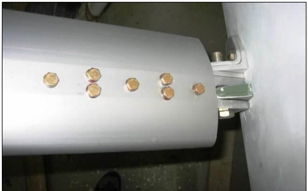
Kuva 4. Oikean puoleisen siiven tuen alapään kiinnitys runkoon.
