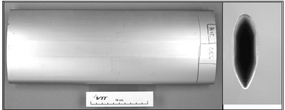
Kuva 2. Vertailunäytteeksi toimitettu käyttämätön siipituen kappale.
