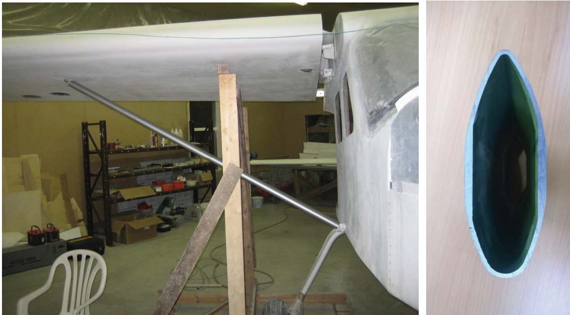
Kuva 1. Tutkittava siipituki ja siinä käytetyn profiilin muoto (OTKES).
