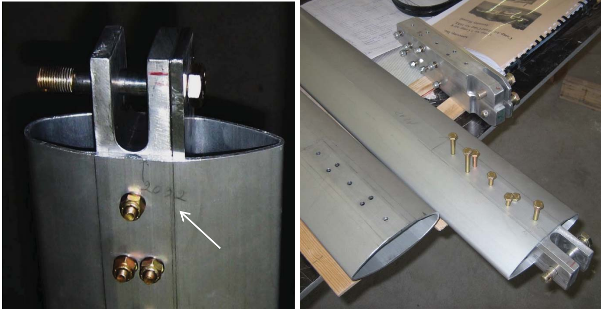
Kuva 2. Vasemmassa kuvassa näkyy siipituen alapään kiinnitys ja profiilissa esiintyvä pituusmerkintä. Oikeassa kuvassa näkyvät myös siipituen yläpään kiinnityselimet (OTKES).
