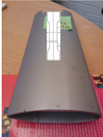
Kuva 2. Skemaattinen irrotuskuva: vetokoesauvat (yhteensä 2 kpl) irrotettiin pitkittäissuunnassa siipituen referenssipalan ylä- ja alapinnalta.
