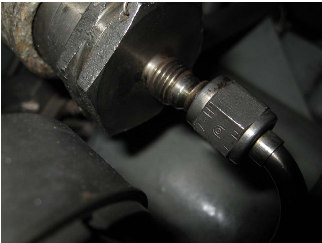
Kuva 5. Moottorin säätöilmapiutkiston suodattimen jälkeisen liittimen mutteri kuvattuna onnettomuuden jälkeen.
