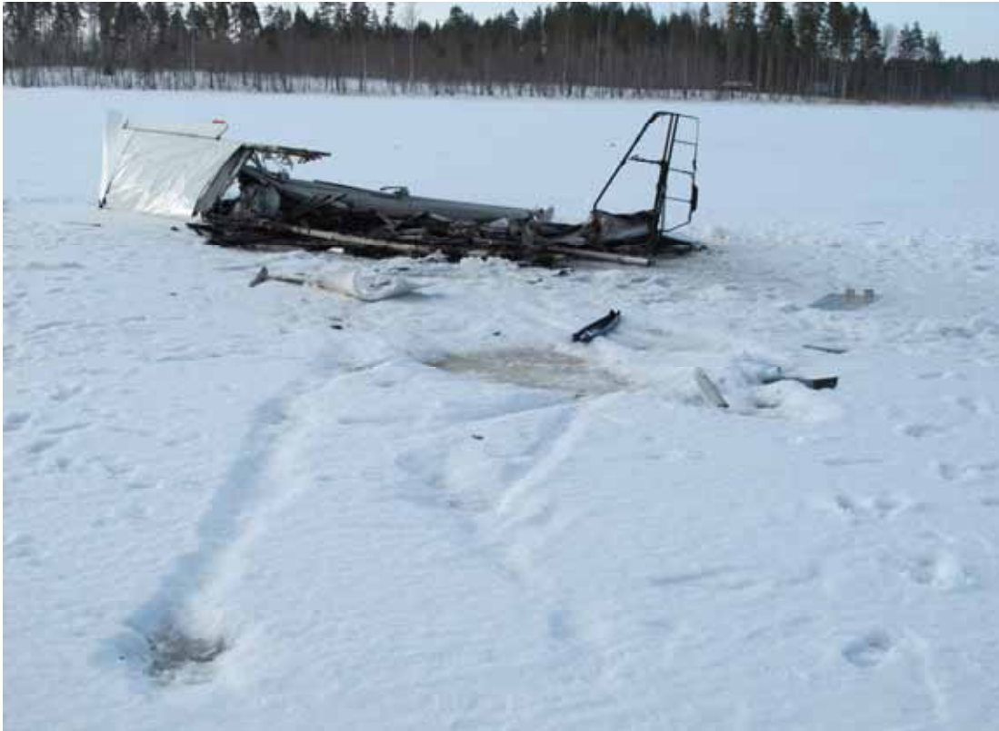
Kuva 2. Etualalla vasemmalla näkyy vasemman siiven iskujälki, siitä oikealla siipitukien jälki sekä rungon ja kellukkeiden jäljet. Törmäyksen jälkeen kone on pompannut muutaman metrin etuoikealle.
