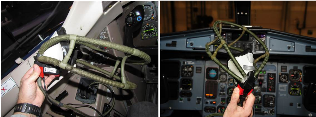
Kuva 7. Vasemmassa kuvassa on ATR-simulaattorin happinaamari ja oikeassa kuvassa lentokoneen OH-ATL happinaamari. Simulaattorin happinaamarin kiinnityshihnat ovat löystyneet käytössä.
