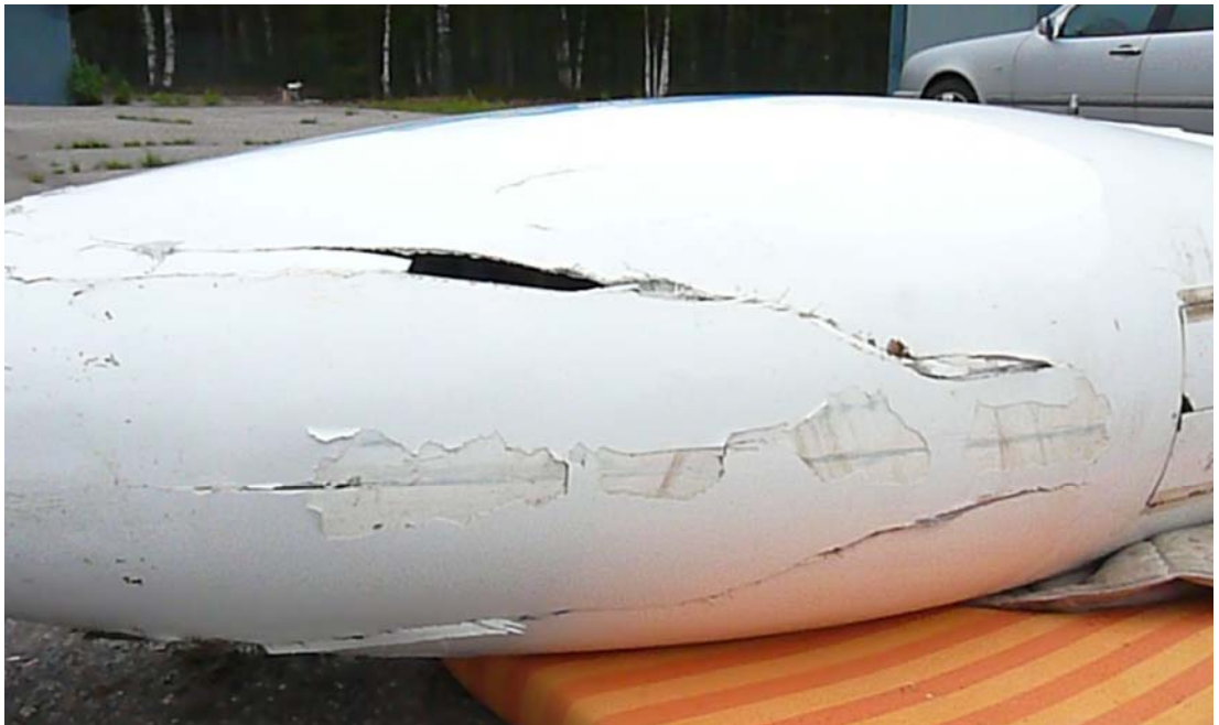
Kuva 3. BO:n eturungon yhteentörmäyksessä vaurioitunut pohja.
