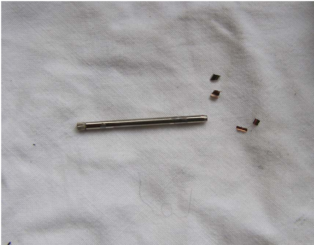
Kuva 3. Kohon akselitappi, josta nikkelpinnoitus on paikoitellen irronnut.
