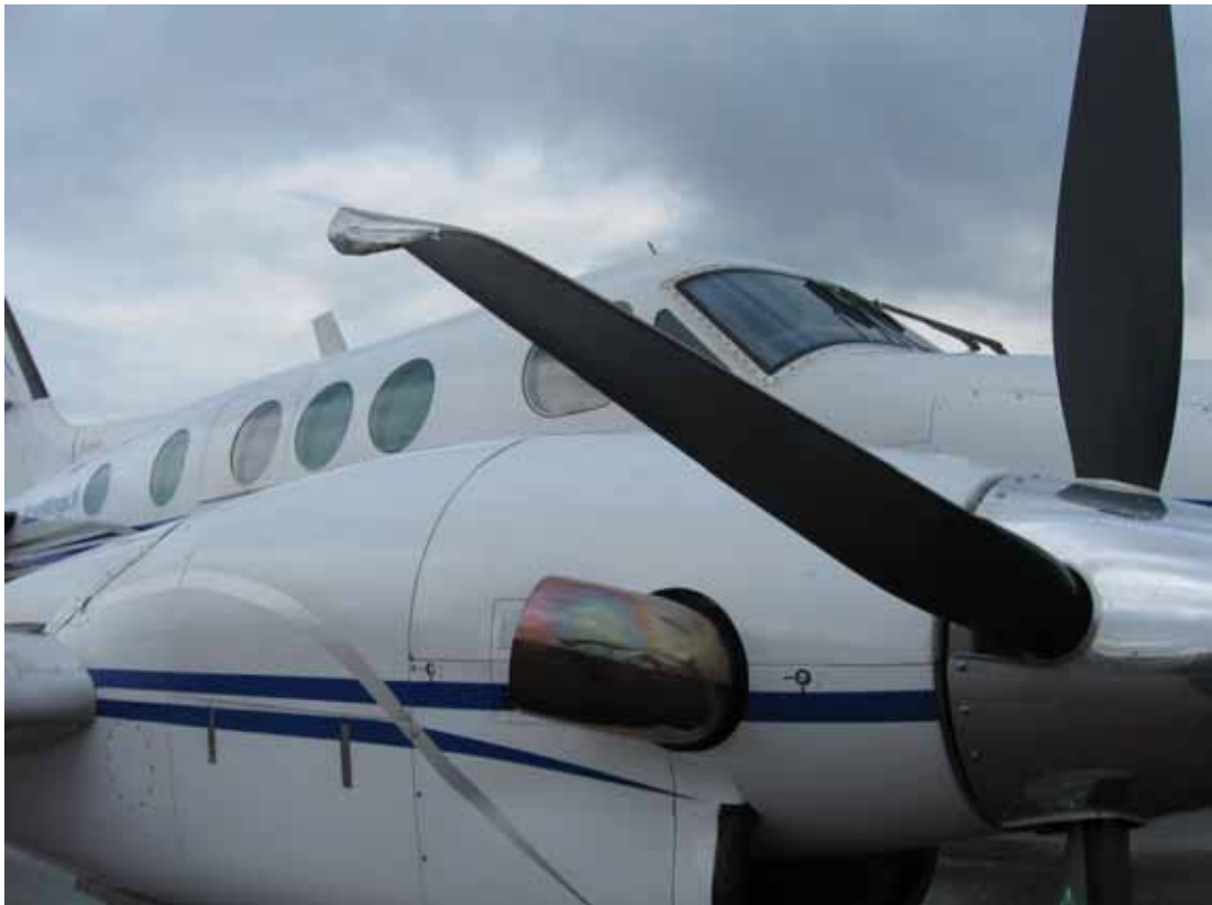
Kuva 1. Oikean moottorin vaurioituneet potkurinlavat. Lähde: Poliisi.
