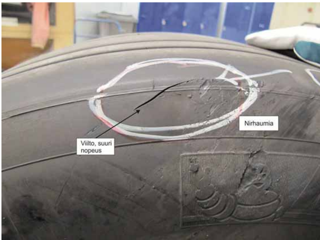
Kuva 5. Vaurioita päätelineen renkaassa.
