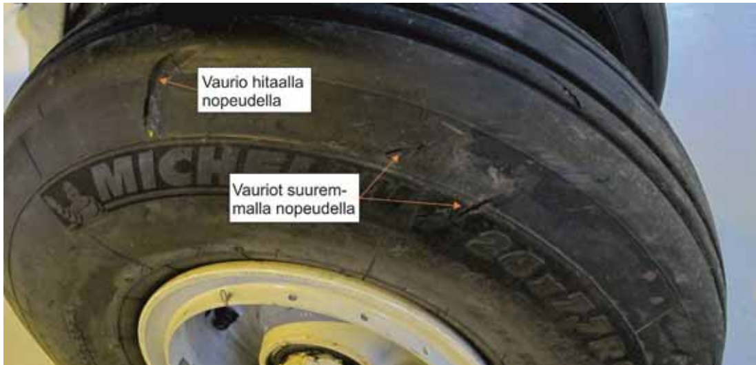
Kuva 4. Vaurioita nokkatelineen renkaassa.
