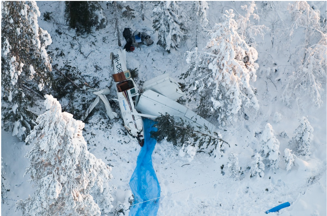
Kuva 3. Lentokone onnettomuuden jälkeen lentosuuntaa vastaan kuvattuna. Sininen muovikalvo on maahan vuotavan polttoaineen keräämistä varten.
