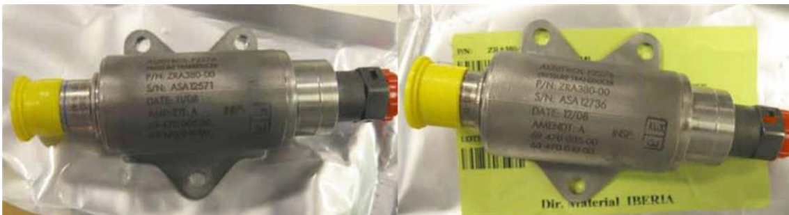
OH-LTO:n oikeasta moottorista irrotetut paineanturit, vas. s/n ASA12571 ja oik. s/n ASA12736
