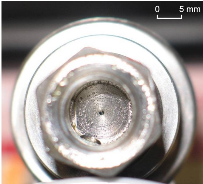
Kuva 16. Vasemman moottorin vuodatusilmajärjestelmästä 13.12.2010 irrotettu paineanturi Pr. Paineliitännässä kohdassa kello 7 näkyy iso vesipisara. Lähde: Finnair Technical Services Oy.
