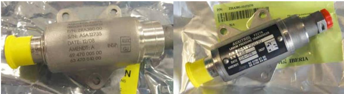
OH-LTO:n vasemmasta moottorista irrotetut paineanturit, vas. s/n ASA12735 ja oik. s/n 188
