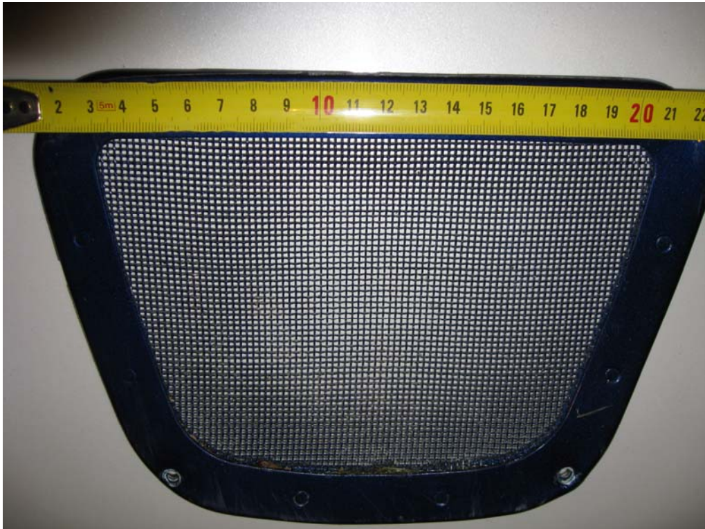
Kuva 5. Moottorin imuilman metalliverkko. Silmäkoko on 1.6 mm.
