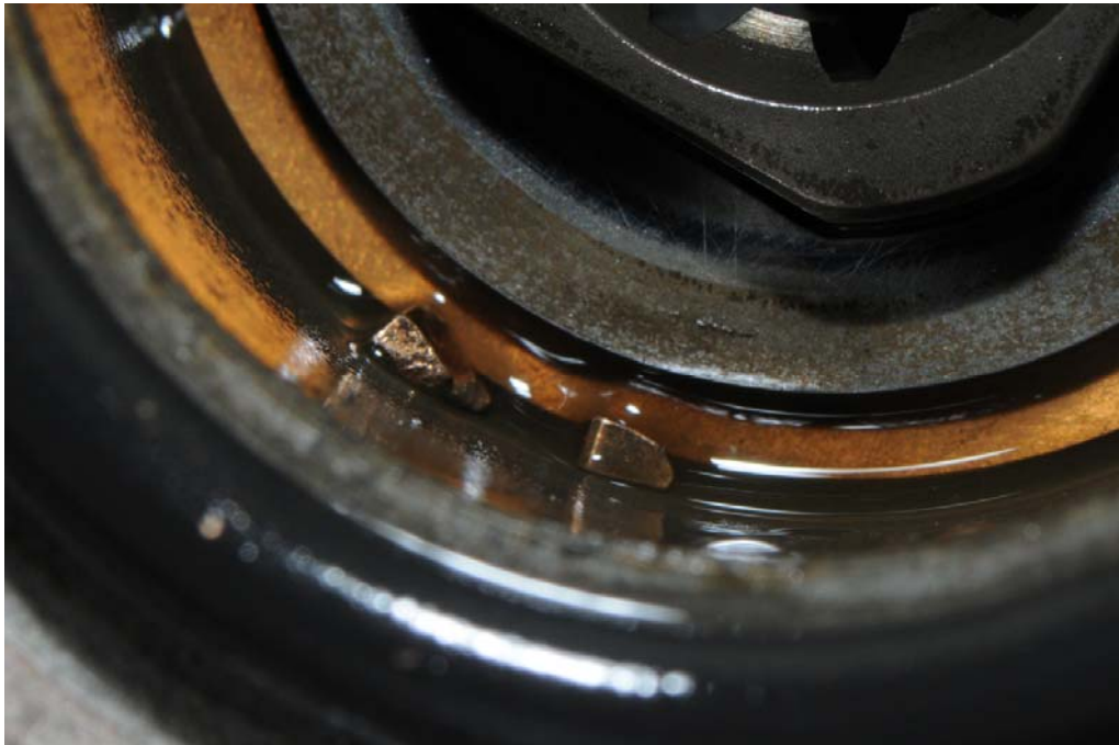
Kuva 3. Pumpun pronssisen tiivisterenkaan käyttökorvakkeet olivat murtuneet irti.
