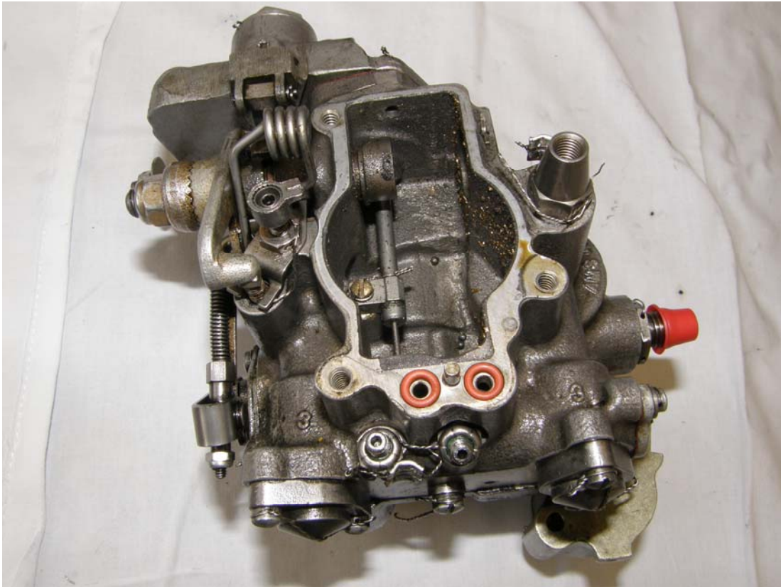
Kuva 2. Moottorin polttoainesäädin avattuna
