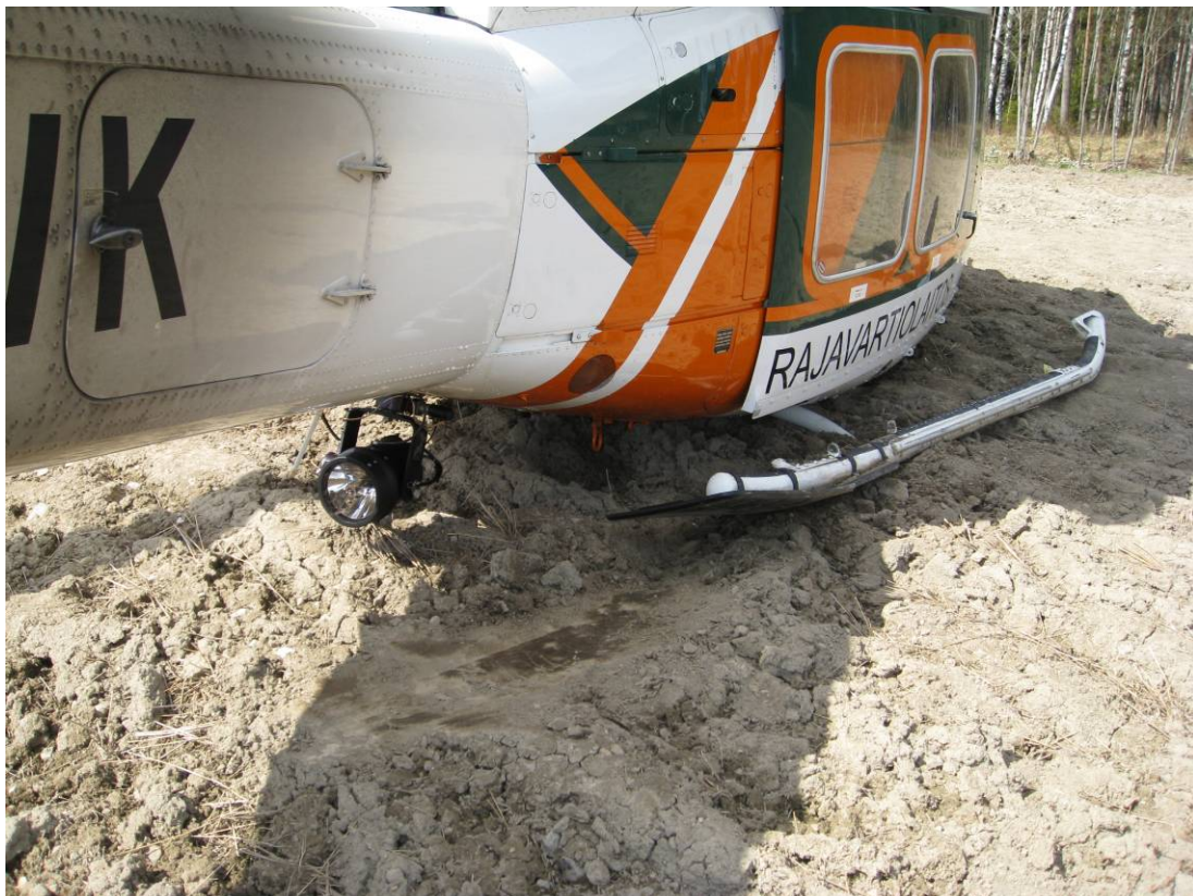
Kuva 9. Vauriot helikopterin oikealla puolella. Kuvassa näkyy jalaksen liukujälki.
