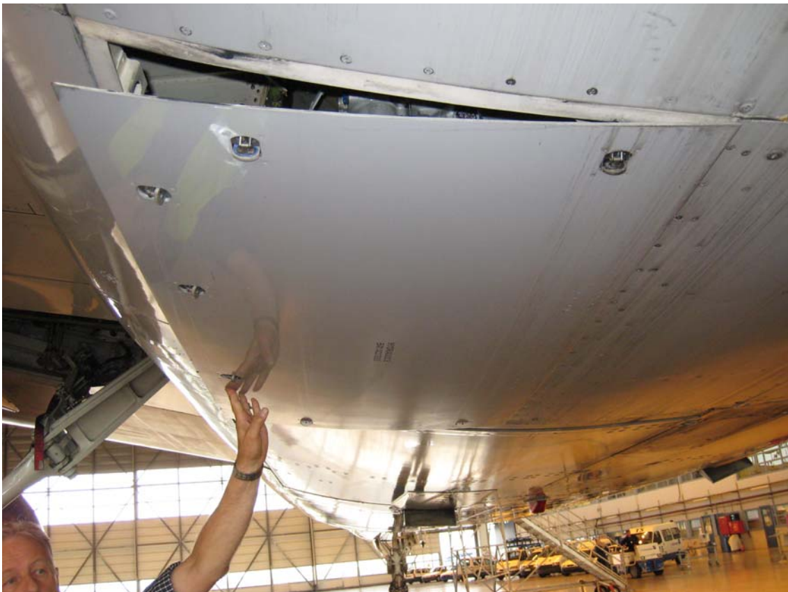
Kuva 1. Vastaava hydraulitilan huoltoluukku, joka repeytyi irti lennolla.
