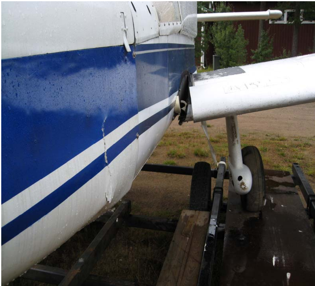
Kuva 3. Repeytynyt siiven kiinnitys
