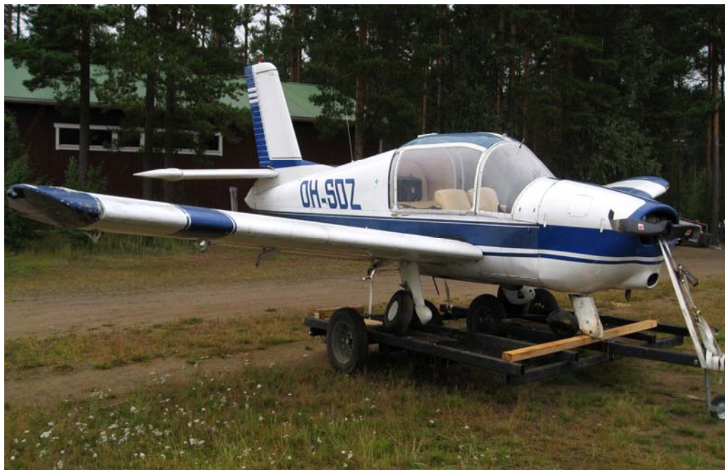
Kuva 1. Vaurioituneet telineet ja potkuri
