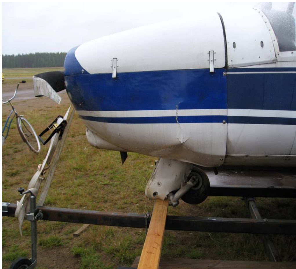
Kuva 2. Vääntynyt potkuri, katkennut nokkateline ja vaurioitunut moottorin suojapelti
