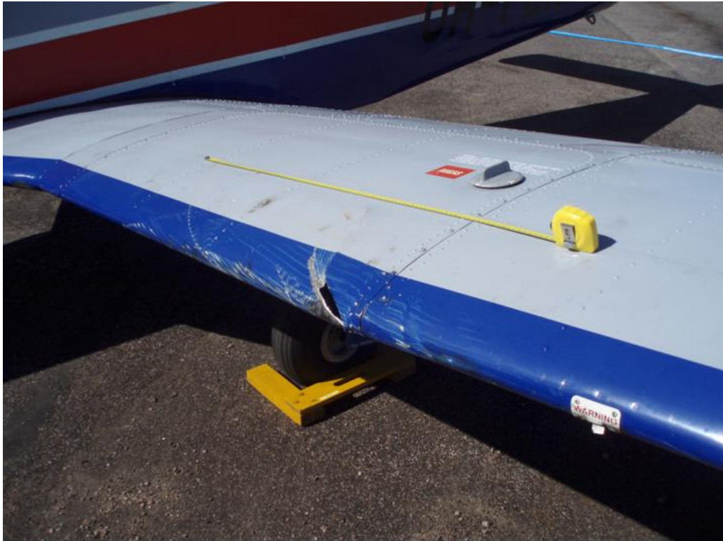
Kuva 2. Vauriot vasemman siiven etureunassa (mitta on yksi metri)
