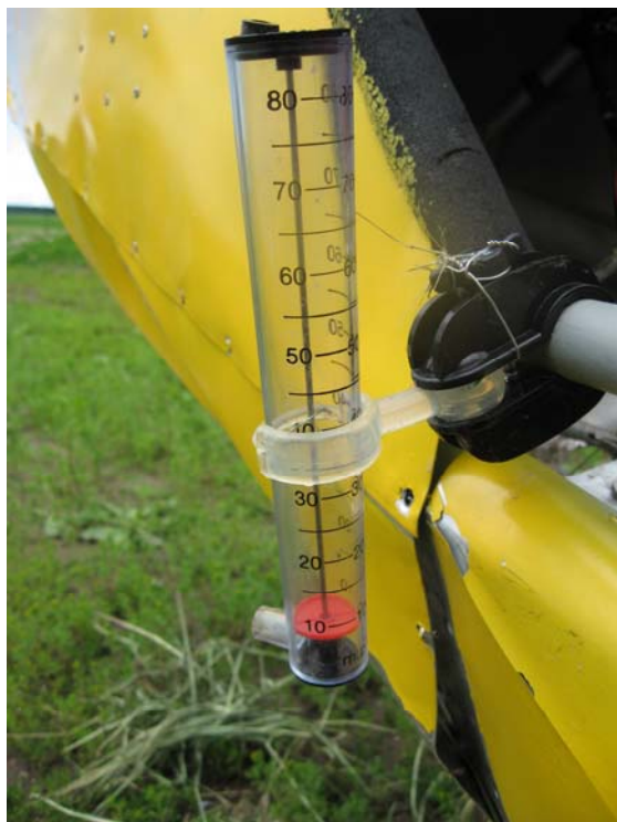
Kuva 4. Ohjaamon ulkopuolelle asennettu ilmanopeusmittarina toiminut tuulimittari
