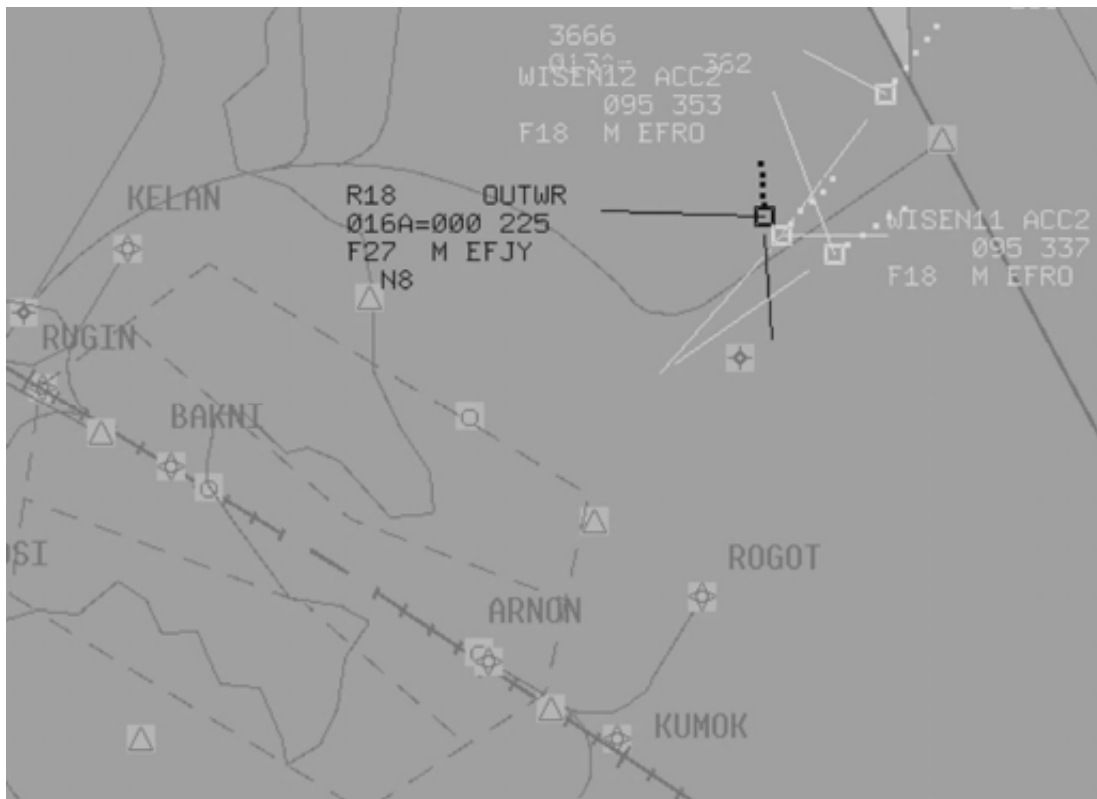
Kuva 3. Eurocat-tutkatallenteen kuva, josta on nähtävissä tilanne, kun Fokker F.27 (R18) ja Hornet-parven johtokone (Wisent 11) sivuuttavat toisensa.
