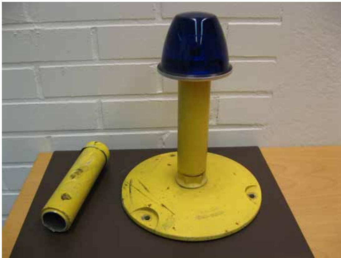
Kuva 4. Rullaustievalaisin ja vaurioituneen valaisimen jalka (vas.)
