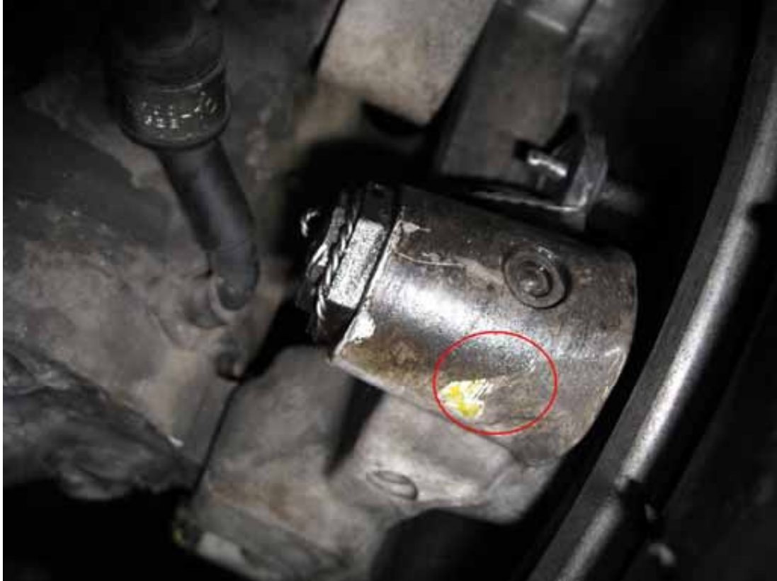
Kuva 3. Keltaista maalia jarruasetelman alapinnalla
