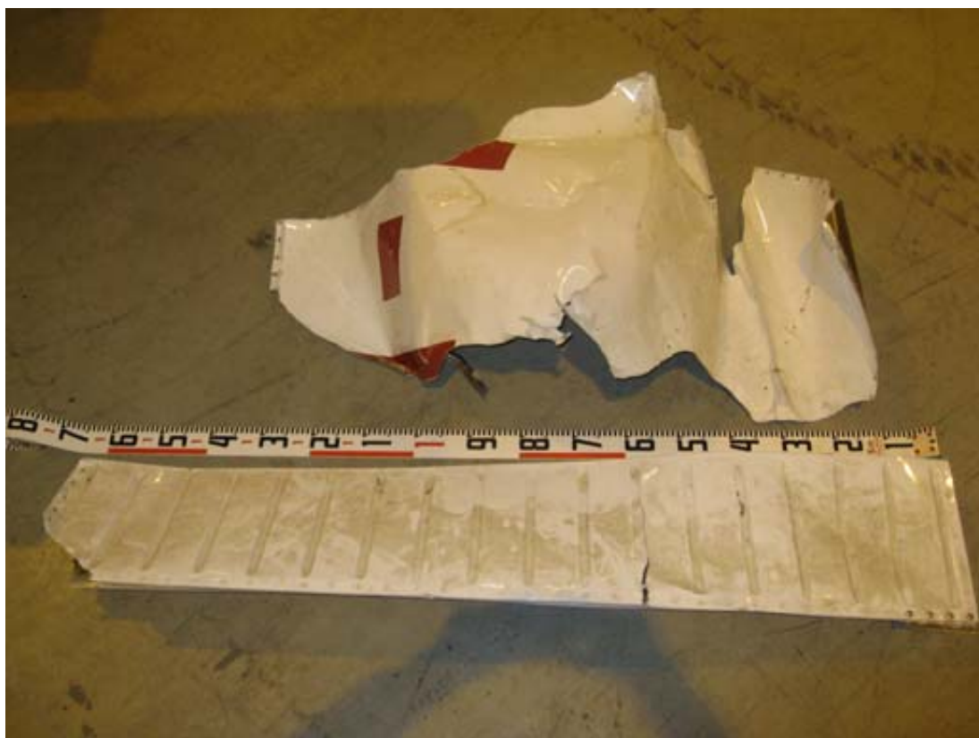
Kuva 5. Etsinnöissä löydettyjä ilmassa irronneita osia
