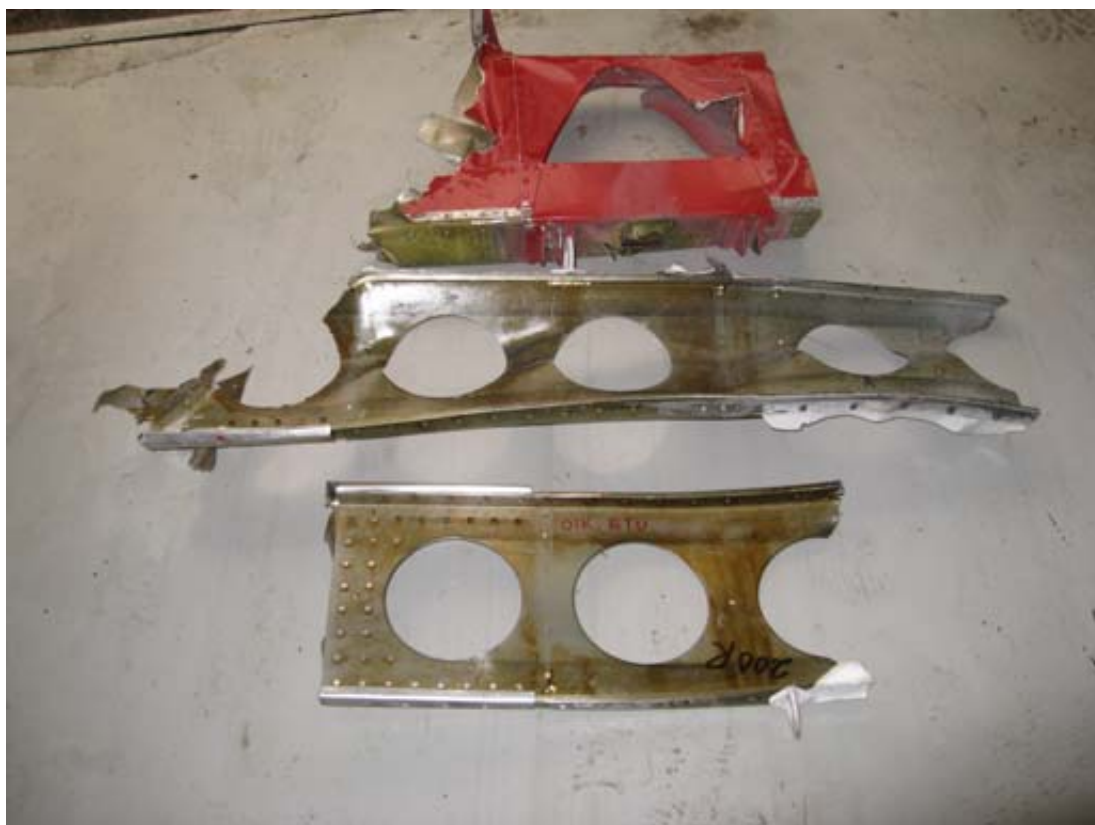
Kuva 6. VTT:llä tutkittuja osia. Ylhäällä osa korkeusperäsintä, keskellä pala vasemman siiven salkoa ja alhaalla pala oikean siiven salkoa (kaikissa osissa murtopinta vasemmassa päässä).
