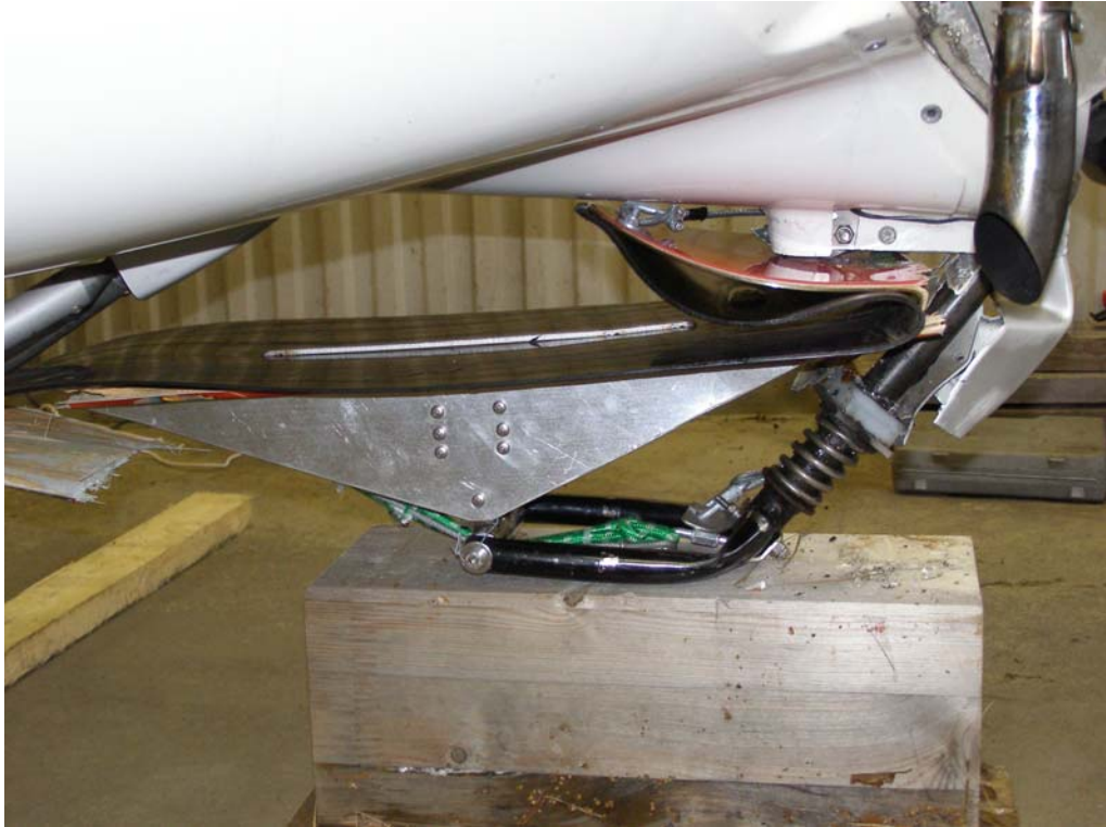
Kuva 2. Vaurioitunut nokkasuksi ja nokkalaskuteline (lentosuunta vasemmalta oikealle)
