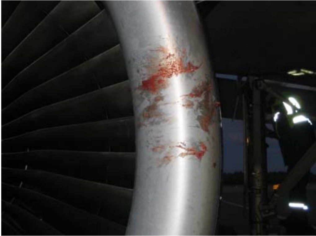
Kuva 2. Osumajälkiä oikeanpuoleisessa moottorissa (kuva Finavia)
