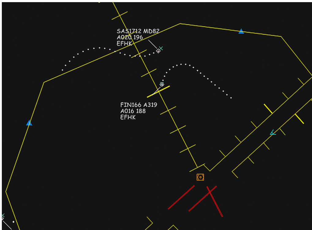
Kuva 1. Tutkatallennekuva FIN166:n ja SAS1712:n lentoradoista kiitotien 15 loppuosalla.
