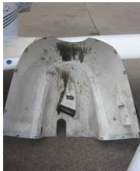
Kuva 8. Vuotojälkiä moottorin alasuojuksessa: Vasemmalla 17.4.2007 ja oikealla 26.4.2007 otetut kuvat
