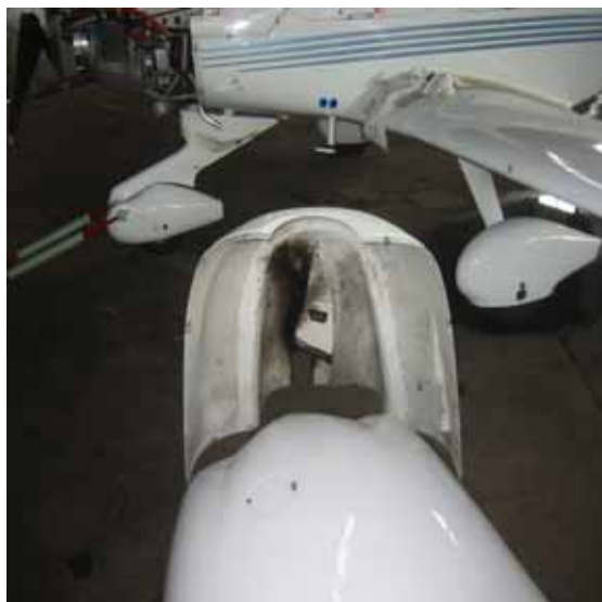
Kuva 8. Vuotojälkiä moottorin alasuojuksessa: Vasemmalla 17.4.2007 ja oikealla 26.4.2007 otetut kuvat
