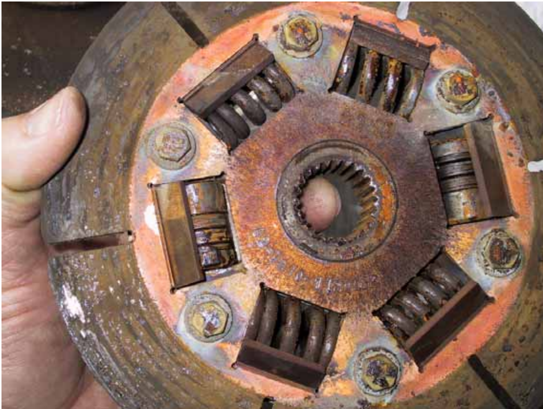
Kuva 2. Pahoin vaurioitunut kytkinlevy
