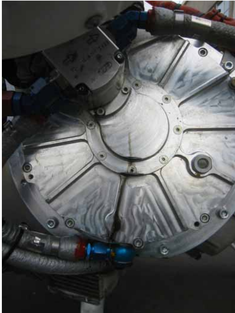
Kuva 7. Kaksoispumpusta vuotanut moottoriöljy valui vaihteiston etupintaa pitkin vaihteiston alareunaan, josta se tippui moottorin alasuojuksen sisäpinnalle
