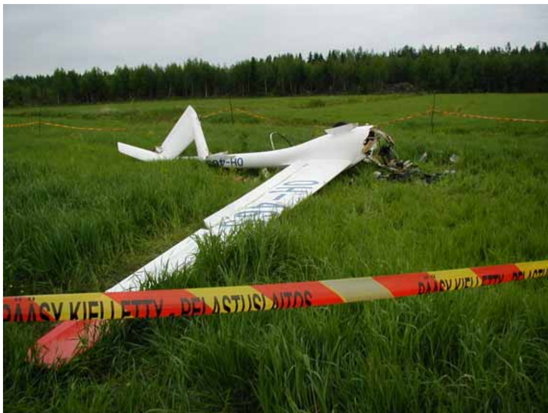
Kuva 3. Maahansyöksyssä tuhoutunut purjelentokone
