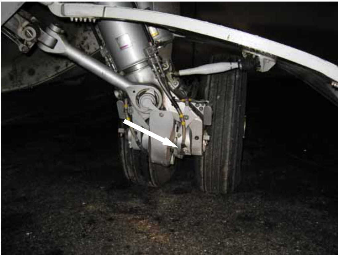
Kuva 2 Vasemmassa laskutelineessä havaittu vaurio. Nuoli osoittaa luistonestojärjestelmän johdotuksen katkeamiskohdan.
