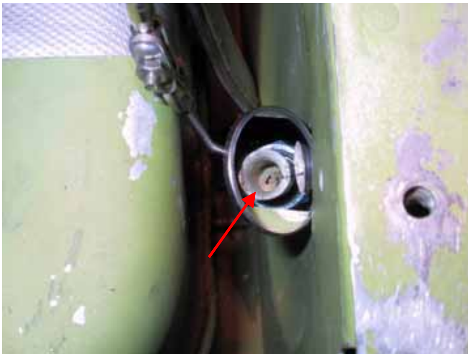
Kuva 2. Säiliön sisällä ollut huohotinputki ja siitä puhdistetut pesän jäännökset
