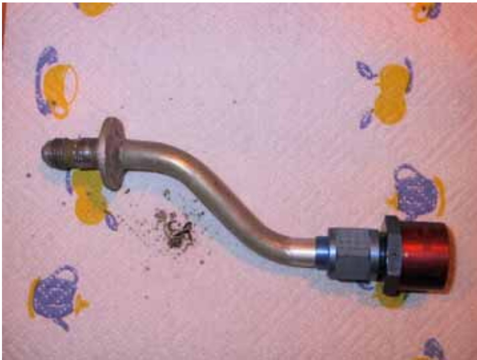
Kuva 2. Säiliön sisällä ollut huohotinputki ja siitä puhdistetut pesän jäännökset
