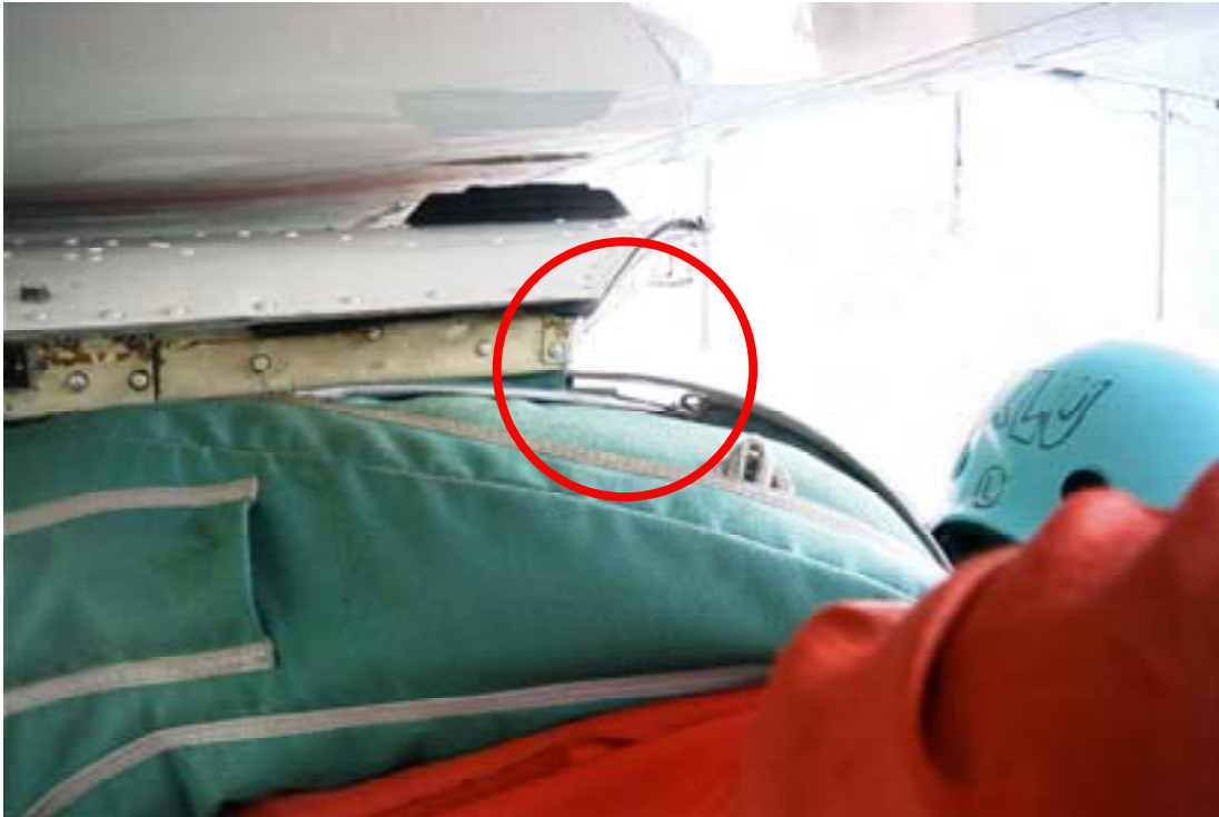
Kuva 6. Lavastettu tilanne varjorepun yläosan mahdollisuudesta takertua hyppyoven ulokkeisiin, jolloin edestakainen liike painaa läpän alla olevat sokat helposti irti
