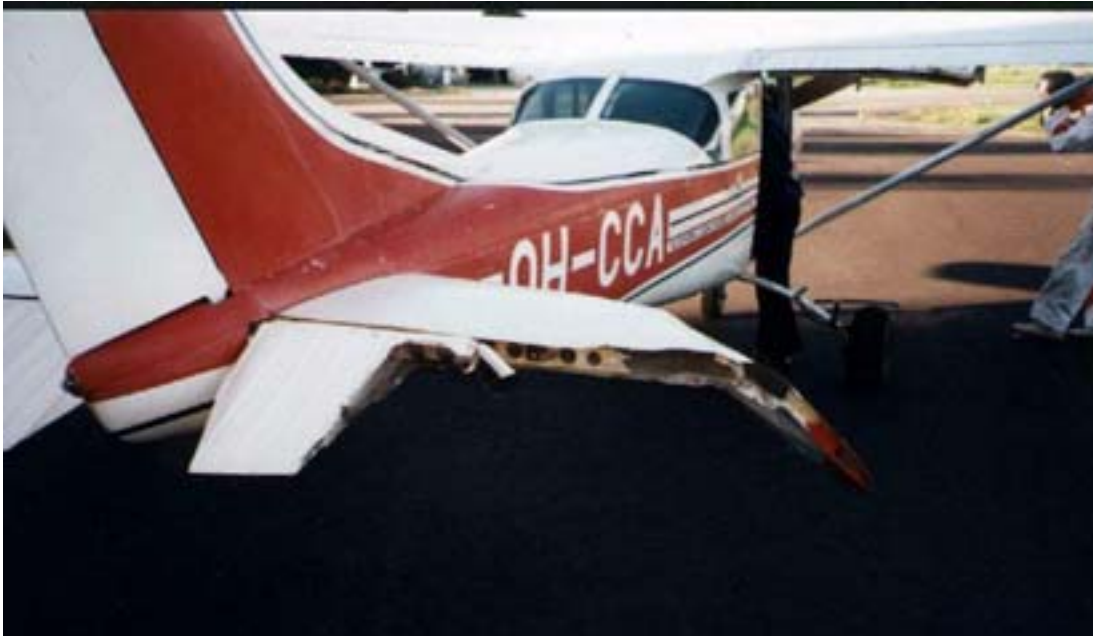
Kuva 3. OH-CCA:n oikeanpuoleisen korkeusvakaajan ja korkeusperäsimen vauriot
