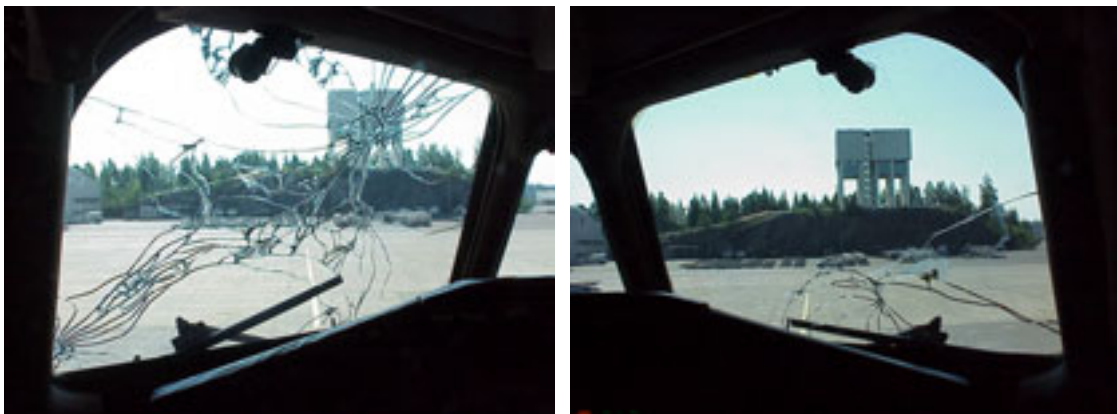
Kuva 7. Ohjaamon vasen ja oikea tuulilasi sisältäpäin katsottuna
