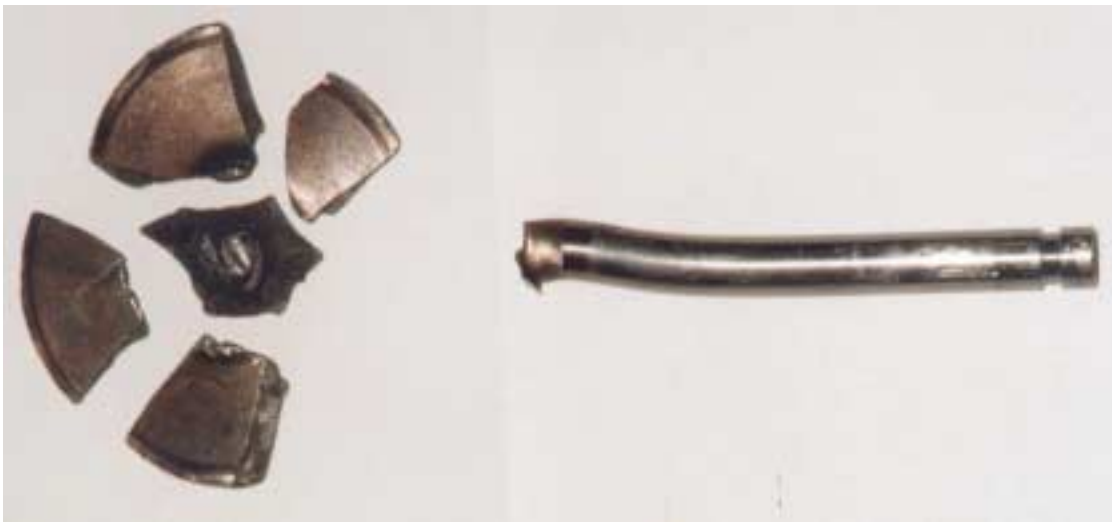
Kuva 7. Kolmossylinterin rikkoutunut imuventtiili
