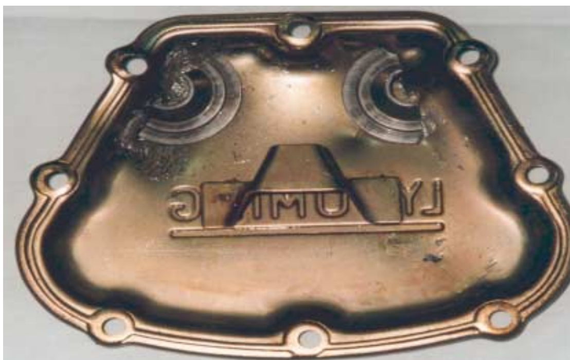
Kuva 4. Haljenneen jousilautasen kappaleiden sijainti venttiilikoneiston kannessa repeämien syntyessä
