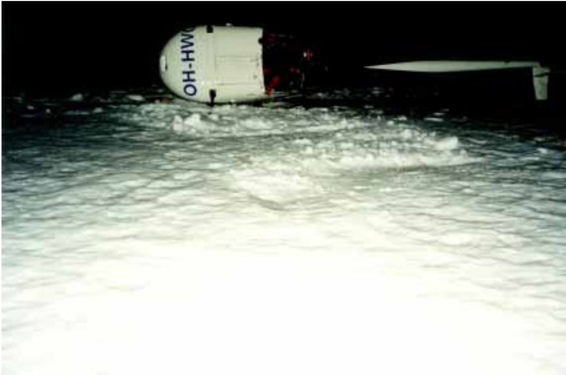
Kuva 3. Helikopteri liukui maassa sivuttain noin viiden metrin matkan, jonka jälkeen se kaatui oikealle kyljelleen.
