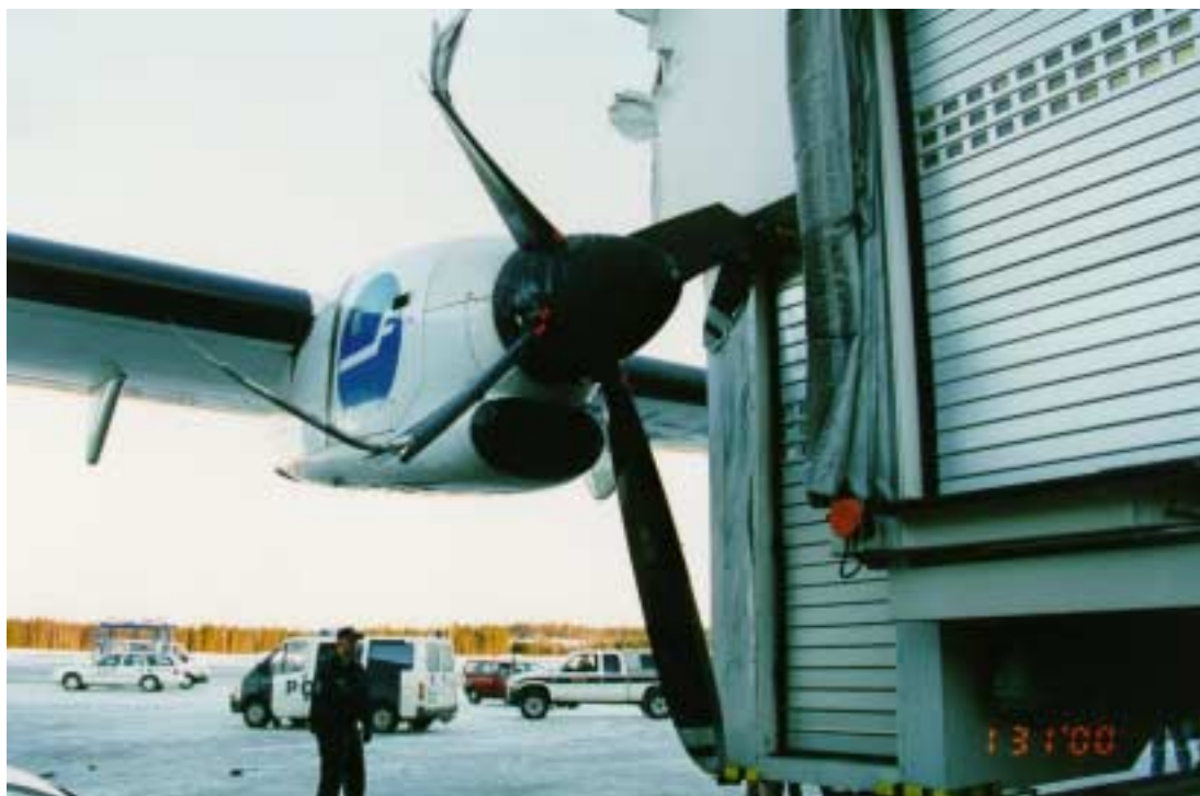
Kuva 1. Potkurin kaikki lavat rikkoutuivat
