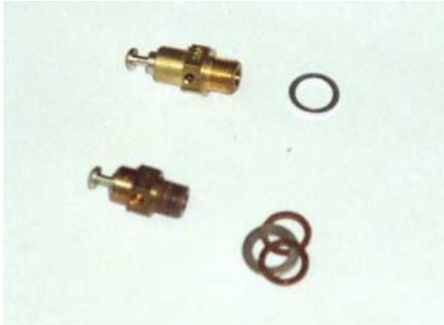
Kuva 4. Vertailukuva neulaventtiileistä, ylempänä vertailuneulaventtiili, alempana ”muutettu” onnettomuuskoneessa ollut lyhennetty neulaventtiili tiivisteineen
