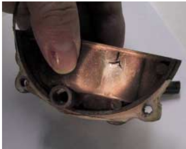
Kuva 3. Tinatulppa ulkopuolelta, imukomun puolelta katsottuna
