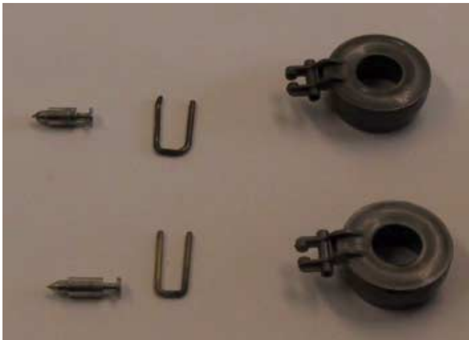
Kuva 5. Vertailukuva neulaventtiilin neulasta, kohon akselist ja kohosta. Ylempänä onnettomuuskoneessa olleet osat.
